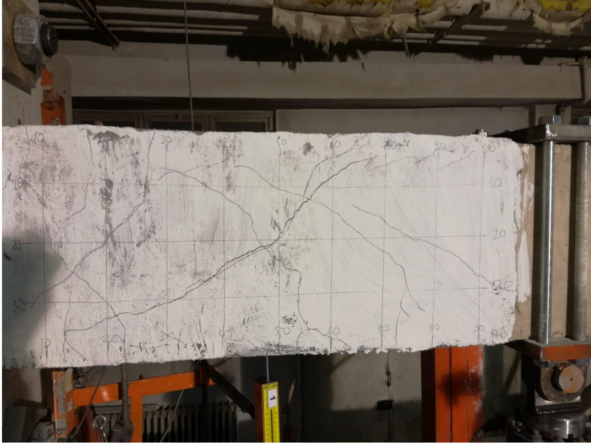
Resim 4.5. MPB numunesi 1. çevrim sonu çatlak görünümü
