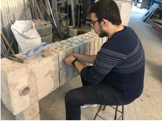
Resim 4.1. Çelik kablo üzerine kelepçe uygulaması
