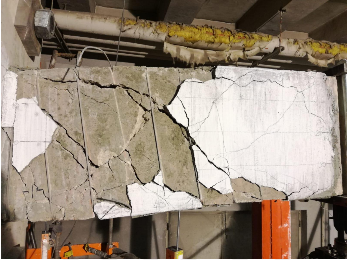
Resim 4.10. MPBC numunesi +85 mm deplasman durumu
