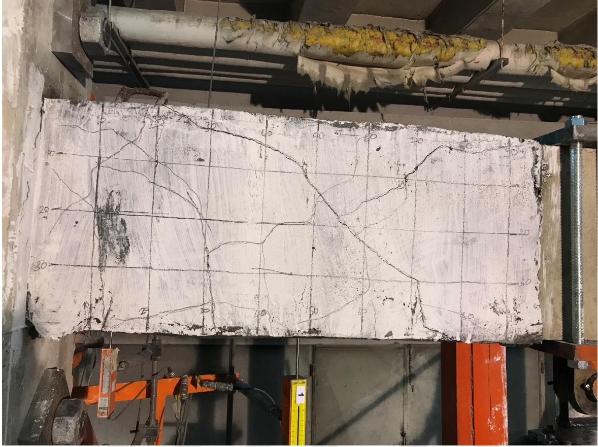
Resim 4.16. HPB numunesi 1. çevrim sonu çatlak düzeni
