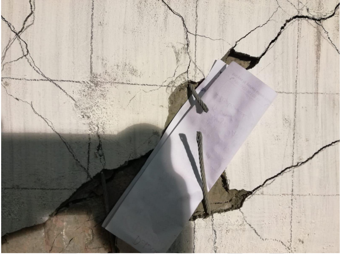
Resim 4.9. MPBC numunesi kablo kesimi
