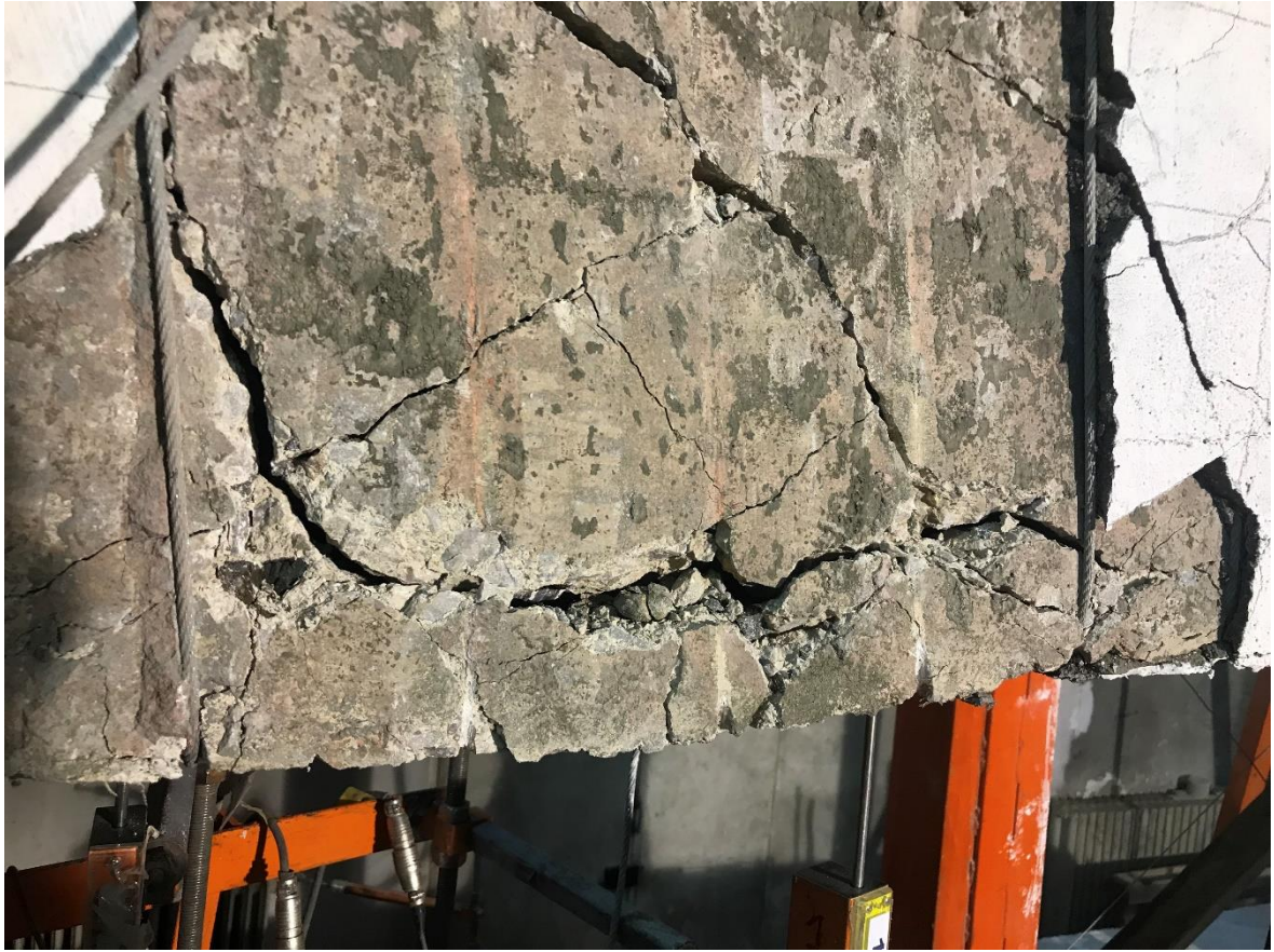
Resim 4.24. HPBC numunesi aderans problemi
