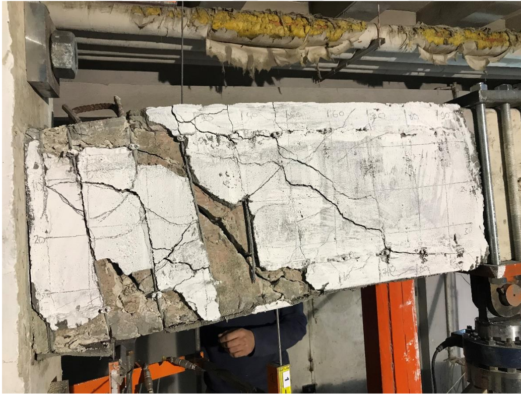
Resim 4.20. HPL numunesi 5. çevrimde kopan çelik kabloyla oluşan kirişin davranışı
