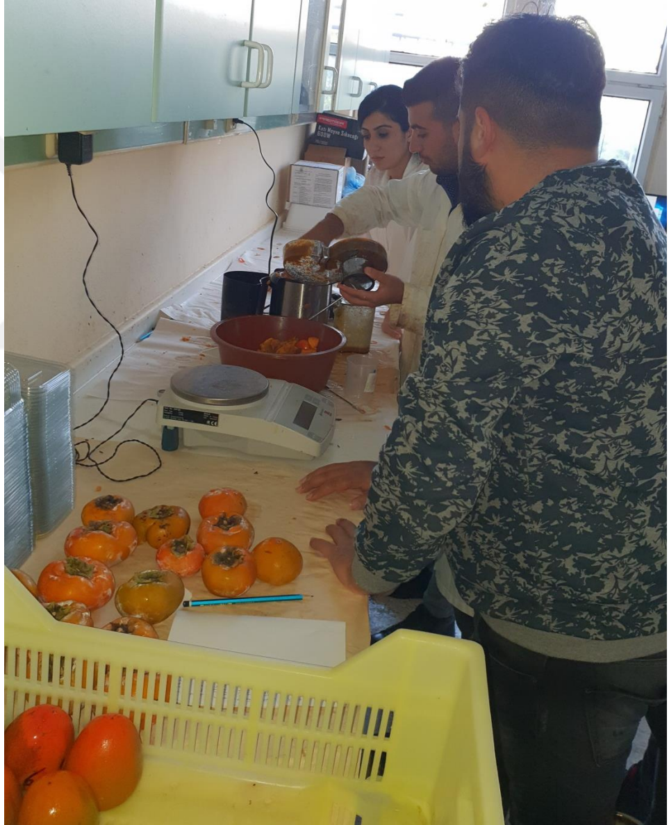
Şekil 3.11. Katı meyve sıkacağı ile Trabzon hurması meyvelerinin meyve sularının çıkarılması
