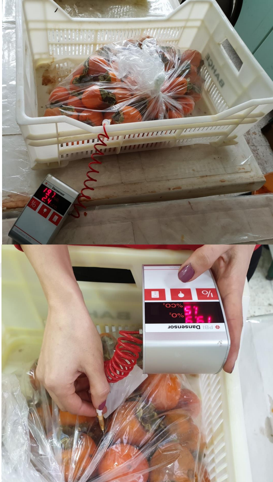
Şekil 3.8. 'Eylül' Trabzon hurması genotipinde ve buruk 'Hachiya' Trabzon hurması çeşidinin MAP torbaları içindeki O 2 ve CO 2 konsantrasyonlarının ambalaj üzerinden taşınabilir gaz analiz cihazıyla ölçümü
