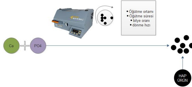
Şekil 2.2. Mekanokimyasal yöntem ile HAP eldesi
