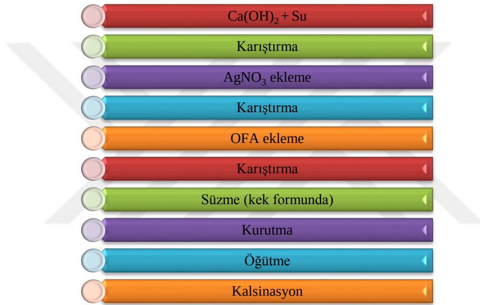
Şekil 2.12. Antibakteriyel kalsiyum fosfat esaslı toz üretim akım şeması
