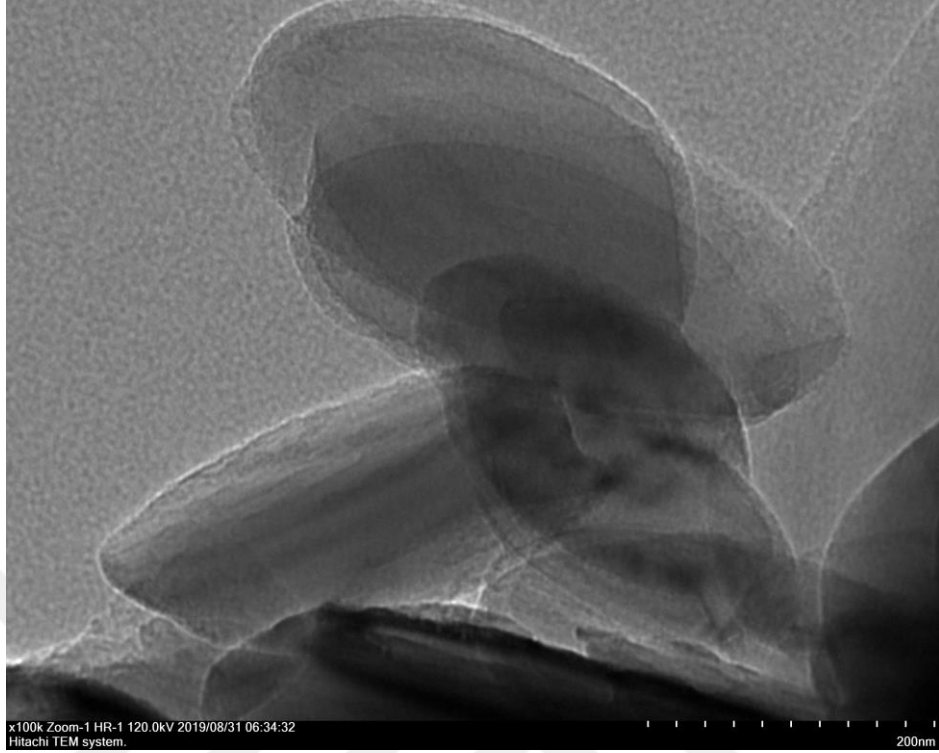
Şekil 4.5. hBN nanopartiküllerinin 200 nm ölçekteki TEM görüntüleri
