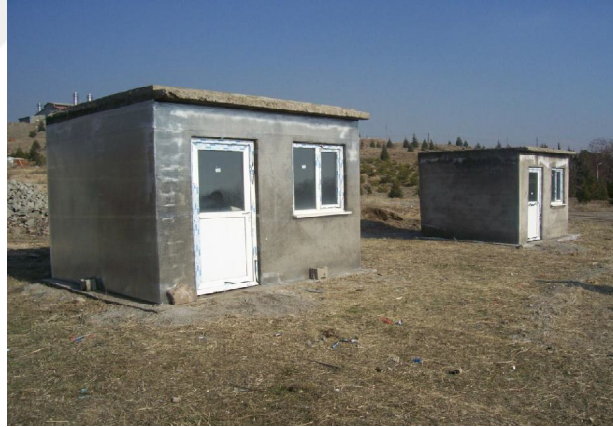
Şekil 3.25 : İnşa edilen test odaları (soldaki oda FDM ile kaplanmıştır).
