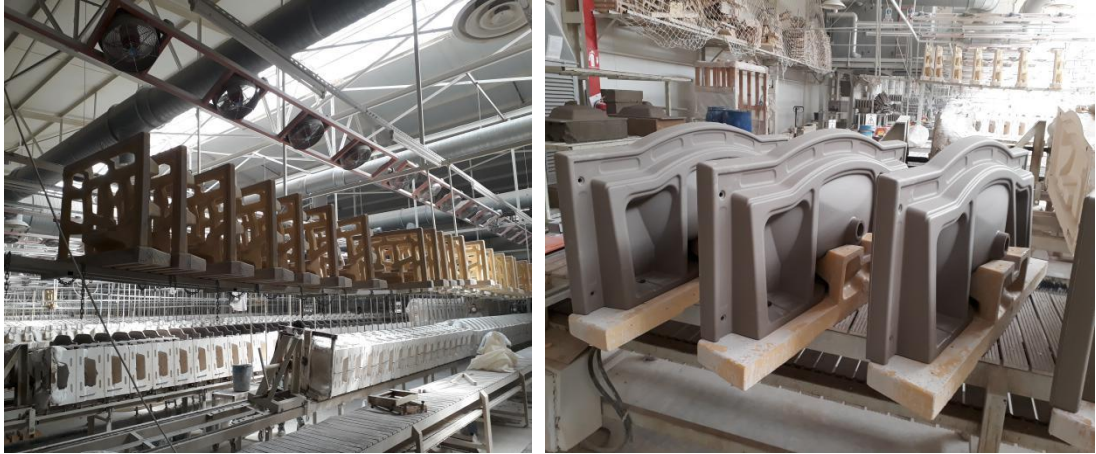
Şekil 4.27. Seramik sağlık gereçleri üretiminde model alma destek aparatı olarak kullanılan sert poliüretan köpük malzeme örnekleri.
