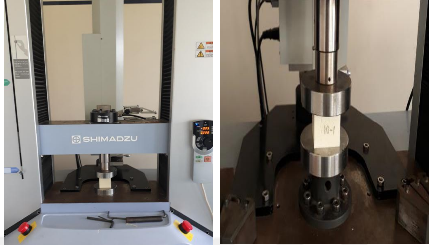
Şekil 2.9. Sert poliüretan köpük numunenin basma test cihazına yerleştirilmesi.
