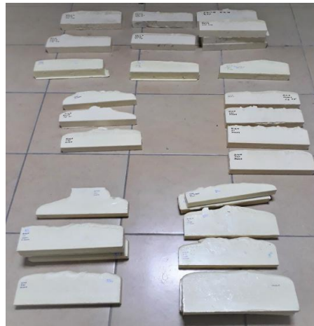
Şekil 2.6. Kalıptan çıkarılan sert poliüretan köpük yapılar.
