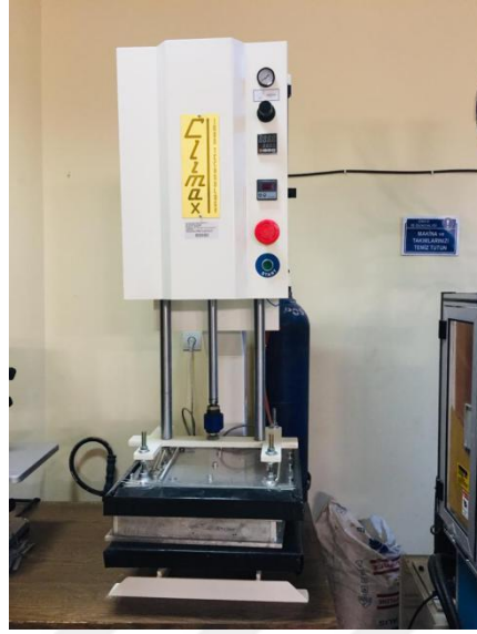
Şekil 2.5. Sert poliüretan köpük malzemenin pres altında kürlenmesi.
