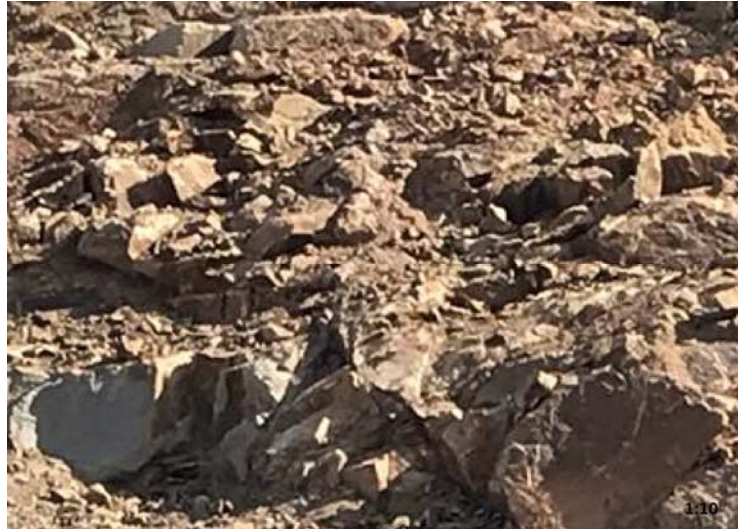
Şekil 3.43: Kaya malzeme sahasından dasit-riyodasit blokları (DSİ ve Sepa Müh. Müş. İnş. Tic. Ltd. Şti, 2015).
