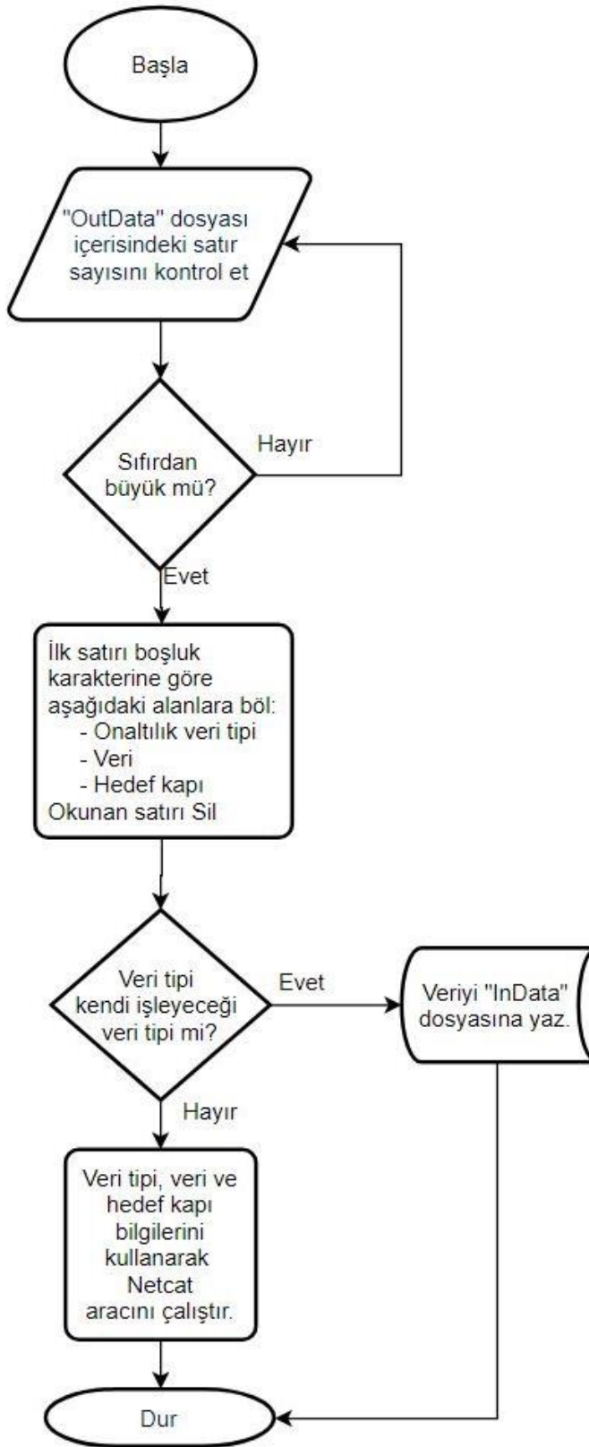
Şekil 5.4. Algılayıcılardan toplanan verilerin iletim için akış şeması
