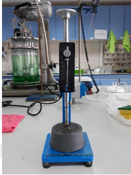
Şekil 3. 9. Çimento pastası kıvam testi
