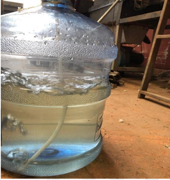
Resim 4.2. Ozonlama esnasında pamuklu tekstil atık suyundaki kabarcıkların görünümü
