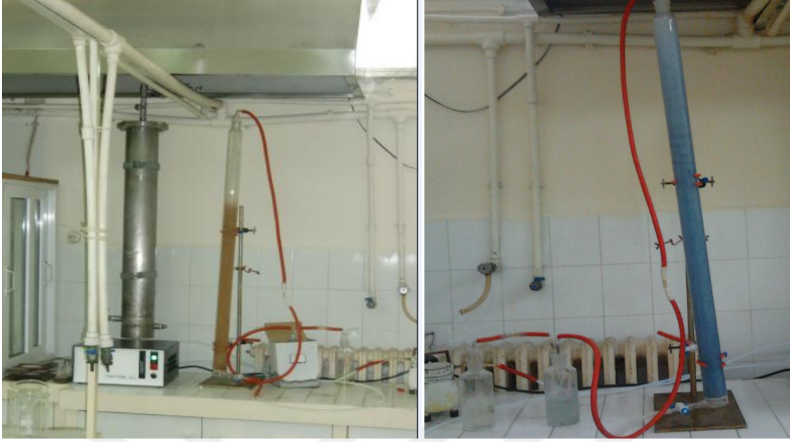
Şekil 2.8. Deneyde kullanılan ozon reaktör düzeneği [35]
