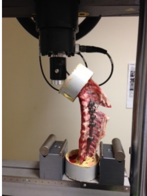
Resim 39. Supraspinöz ve interspinöz bağların eksize edildiği omurga modelinde biyomekanik deney sırasında yetmezlik oluşumu
