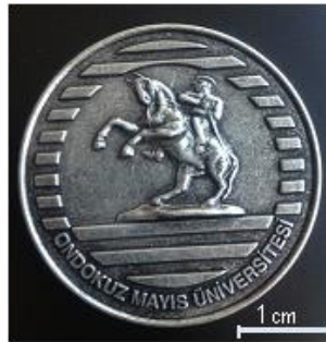
Şekil 4.32. Mikro frezeleme ile işlenmiş kalıpla yapılmış üniversitemiz logosu (TİMAY TEMPO-Merzifon firması izniyle).
