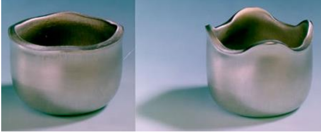
Şekil 3.43. Derin çekilmiş kapta kulak oluşumu [64].
