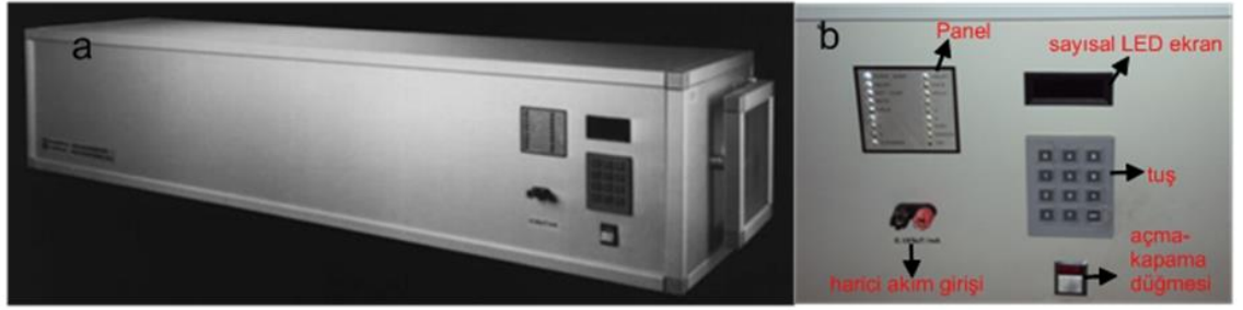
Şekil 3.20: a) MMTD80 ısısal temizleme fırını b) Fırın ölçüm programlamanın yapıldığı ön panelin yakından görüntüsü.
