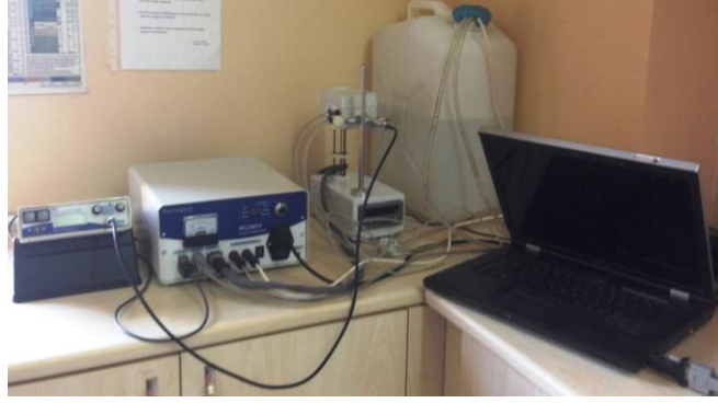
Şekil 3.25: İstanbul Üniversitesi Doç. Dr. Yılmaz İspir Paleomağnetizma Laboratuvarı'nda mağnetik duyarlılık-sıcaklık ölçümleri için kullanılan Bartington MS2 Sistemi.
