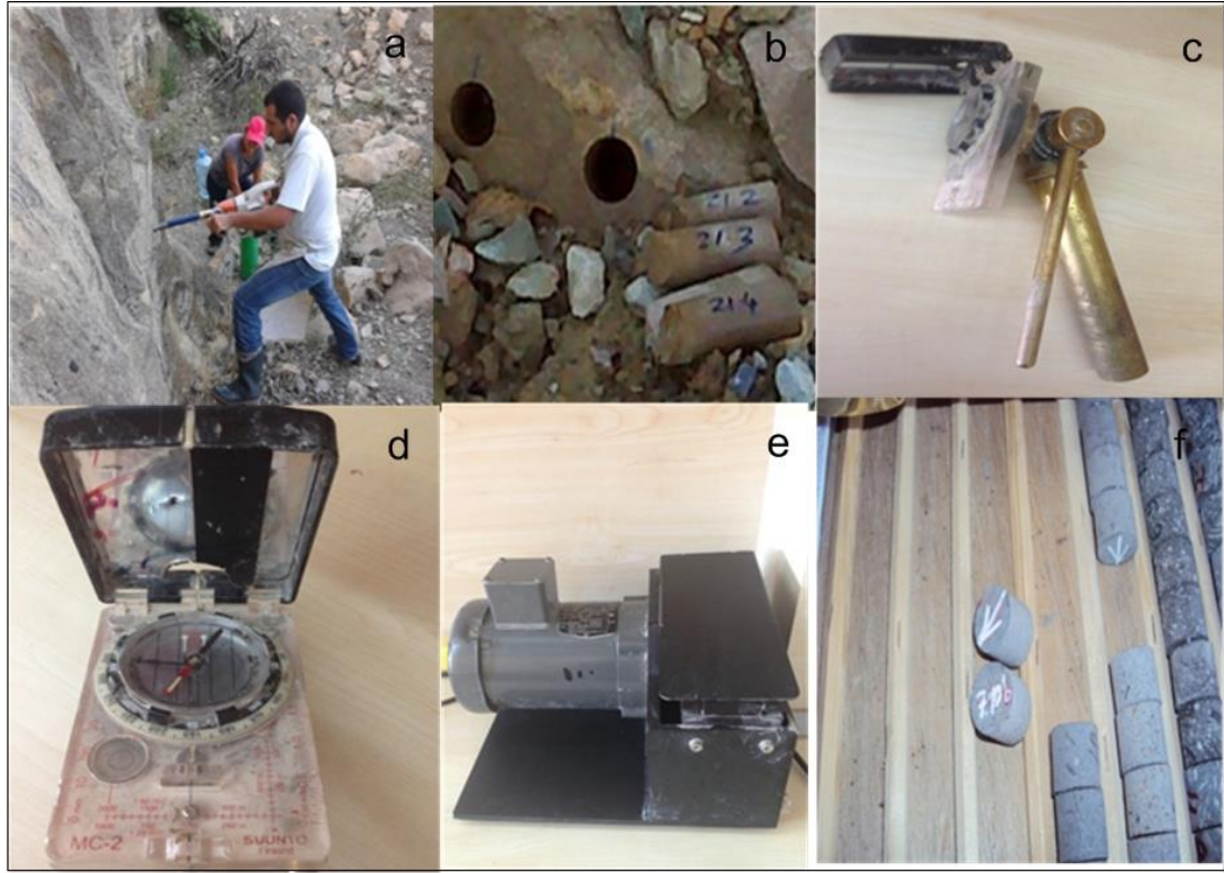
Şekil 3.1: a) Portatif karot alma makinesi b) Alınan örnekler c-d) Pusula ve yönlendirme sehпасı e) Taş kesme cihazı f) Ölçüme hazırlanan örnekler.
