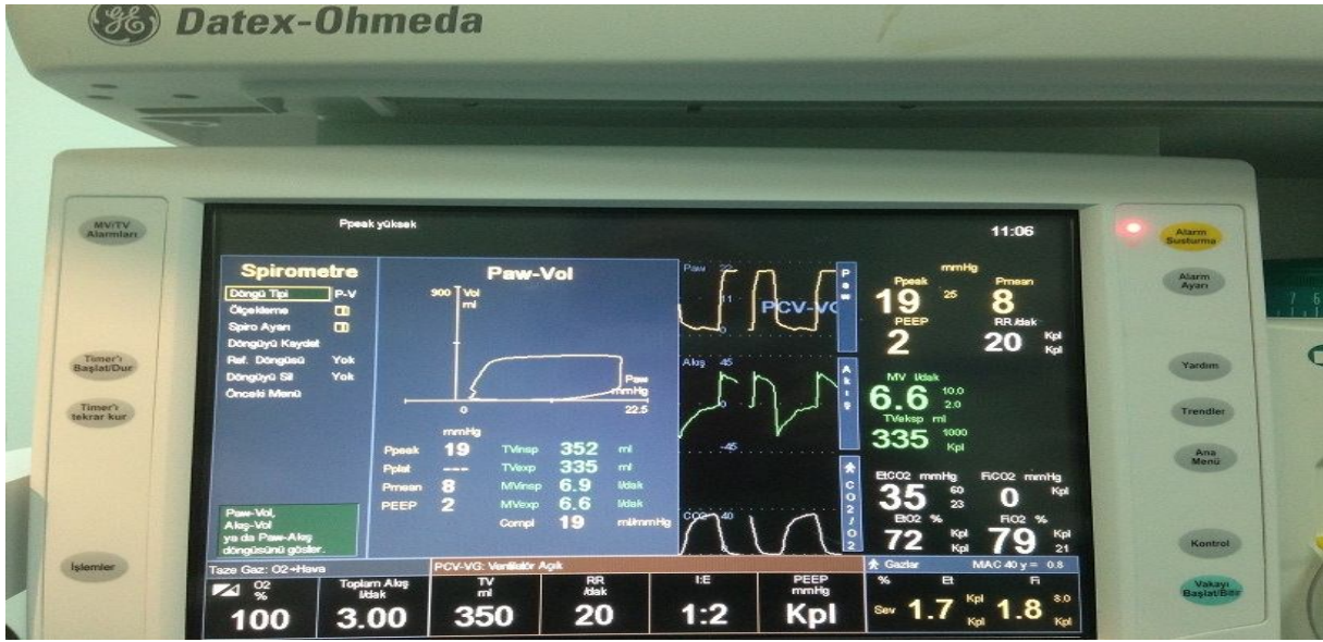
Resim 1. Basınç kontrollü volüm garantili ventilasyonda basınç-akım eğrileri
