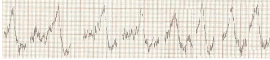
Şekil 4.1. MC-800 Asfaltının benzen çözgen ortamında 60 \text{ mg/7 cm}^3 konsantrasyonlu örneğine ait P_0 NMR sinyalleri.
