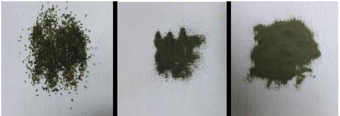
Şekil.3.3. Ulva lactuca bitkisinin farklı partikül çaplarına ait kurutulmuş örnekleri (solda: 30/35 mesh elek altı, ortada: 150 mesh elek üstü, sağda: 150 mesh elek altı)
