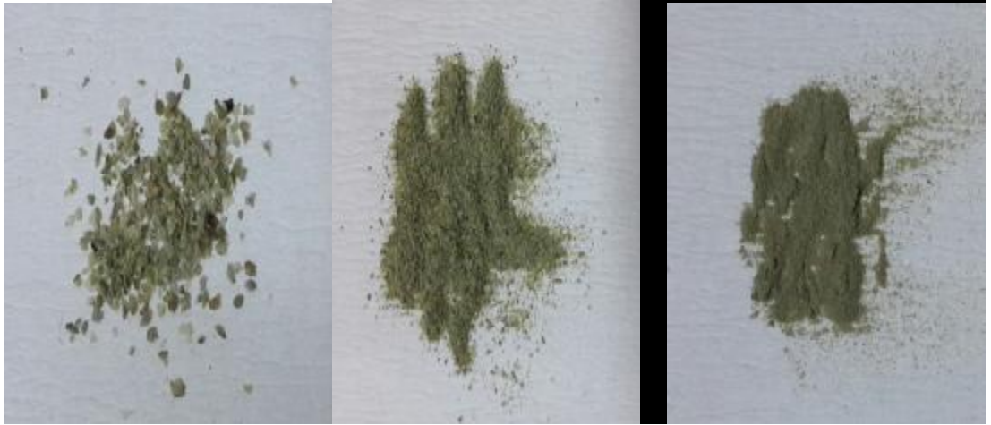
Şekil.3.2. Lemna gibba bitkisinin farklı partikül çaplarına ait kurutulmuş örnekleri (solda: 30/35 mesh elek altı, ortada: 150 mesh elek üstü, sağda: 150 mesh elek altı)
