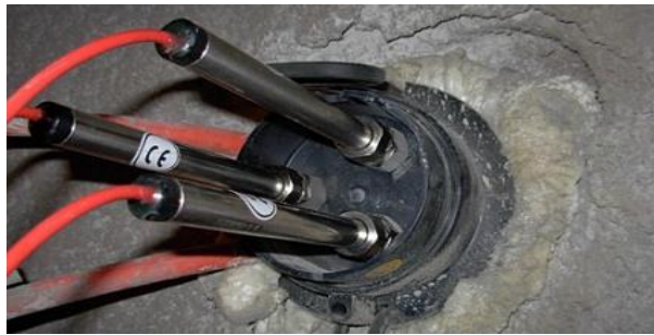
Şekil 2.37: Ekstansometre ölçüm seti elemanları.
