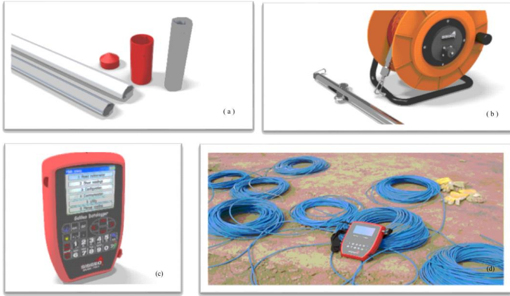
Şekil 2.36: İnklinometre ölçüm seti elemanları.
