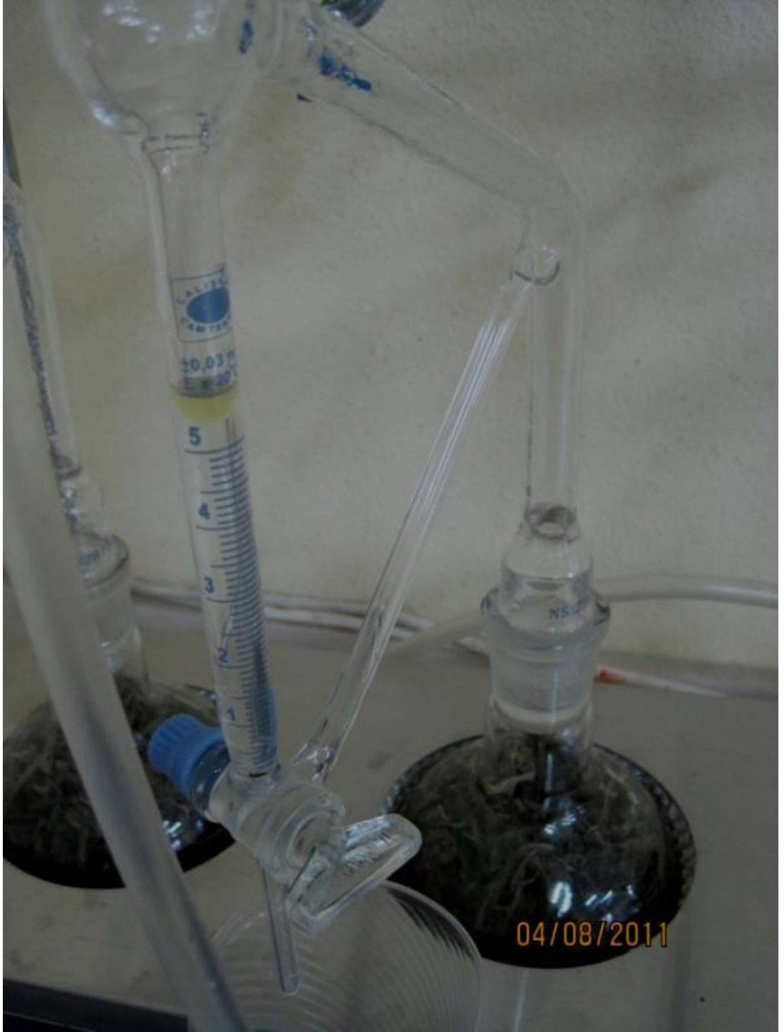
Şekil 3.6. Tıbbi adaçayı klonlarının Clevenger cihazında damıtılması
