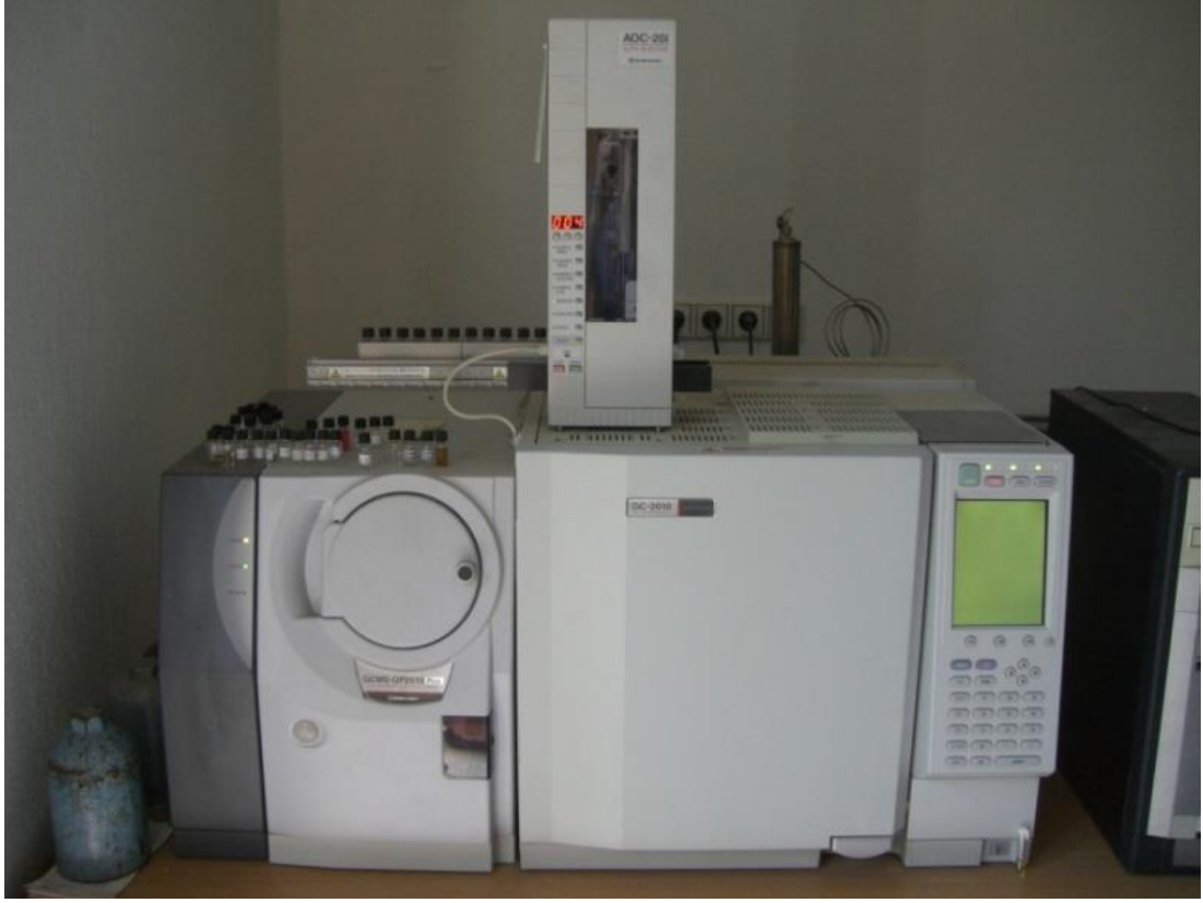
Şekil 3.7. GC-MS cihazında uçucu yağ bileşenlerinin belirlenmesi
