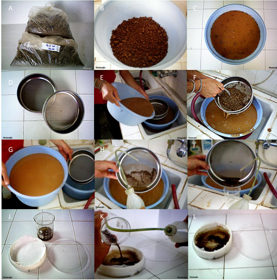
Şekil 3.2. A) Bağ alanlarından alınmış toprak örnekleri, B) Kesekleri parçalanmış analize hazır toprak örneği, C) Soğuk suyla muamele edilmiş toprak örneği, D) Analizde kullanılan elek serileri, E-F) Toprak örneğinin kaba kısımlarından arındırılma işlemi, G-I) Topraktaki nematodların elek yöntemiyle elde edilme işlemi, J-L) Elde edilen örneğin petri kabına aktarılması.
