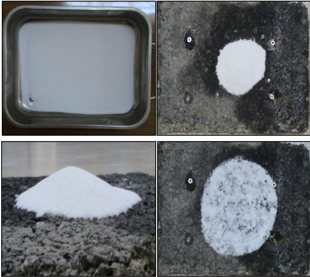
Şekil 5.14 Kum yama yönteminde kullanılan cam kürecikleri, ve yöntemin uygulanması
