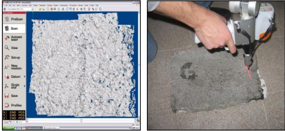
Şekil 5.22 Lazer tarama sistemiyle yüzeyden veri alınması
