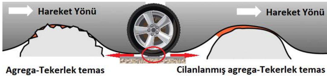
Şekil 7.12 Agregat-tekerlek temas etkileşimi
