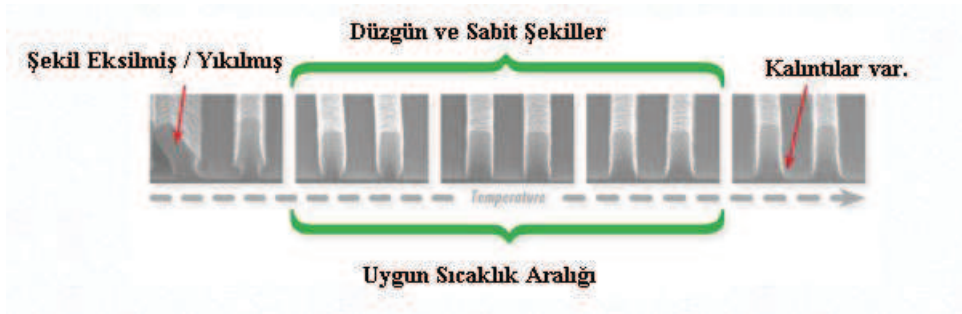
Şekil 3.5: Yansımaya Önleyici Kaplama Sonrası Pişirme Sıcaklığının Etkisi [10].
