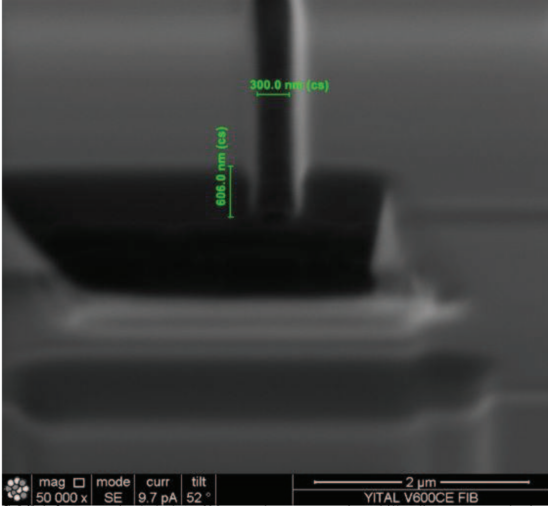
Şekil A.2: Fotorezist kalınlığı 600 nm olan numunenin şekillendirme sonrası kesit görüntüsü
