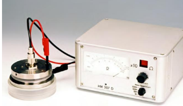
Şekil 2.16. ÜBBÖ kumaşların antistatik özelliklerinin değerlendirilmesinde kullanılan Fetronic Static Lab Tester ölçüm cihazı [238].
