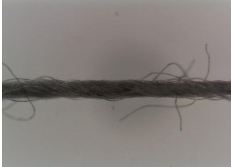
Ek Şekil 2. 45X büyütme oranında %69/30/1 Lenzing FR®/Nexylon FR®/karbon lifi karışım ipliğinin yanal görüntüsü.
