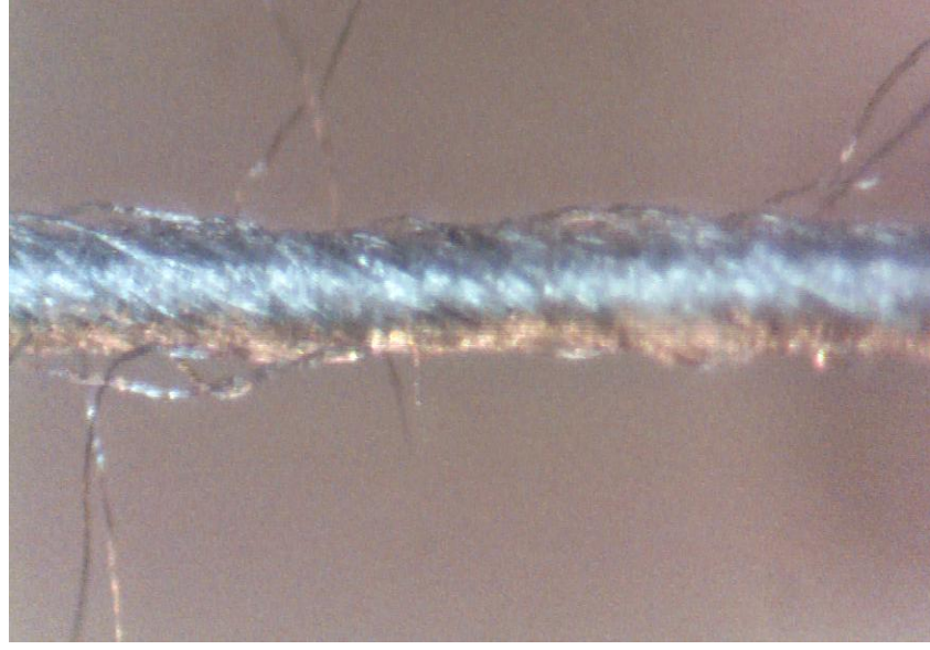
Ek Şekil 5. 45X büyütme oranında %99/1 viskon/karbon lifi karışım ipliğinin yanıl görüntüsü.
