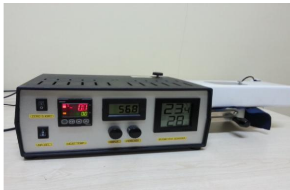
Şekil 2.8. Permetest Su Buharı Geçirgenliği Test Cihazı.
