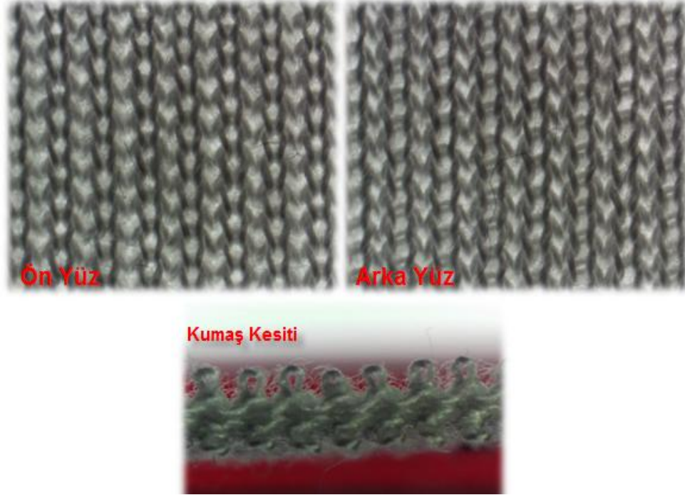
Ek Şekil 8. 10X büyütme oranında U1 kodlu kumaşın yüzey ve kesit görüntüleri.
