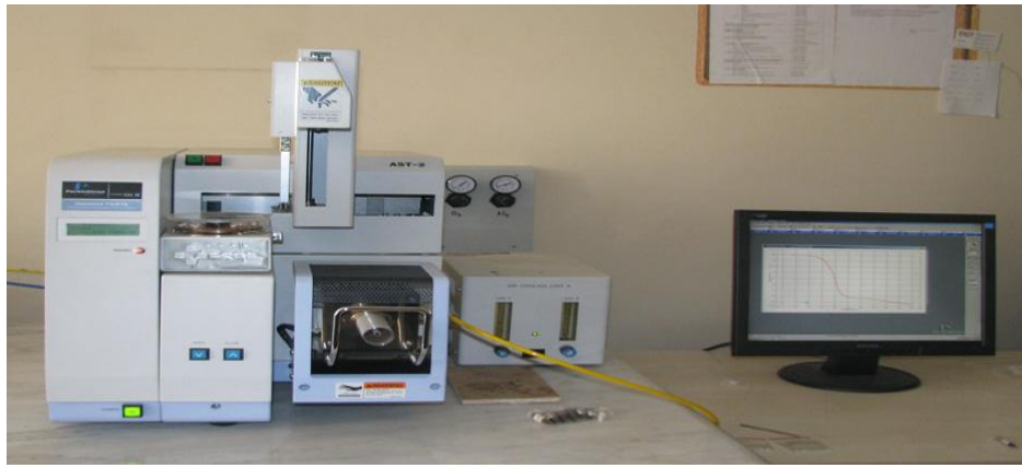
Şekil 2.14. Numunelerin termal analizinde kullanılan Perkin Elmer Diamond TG/DTA cihazı.
