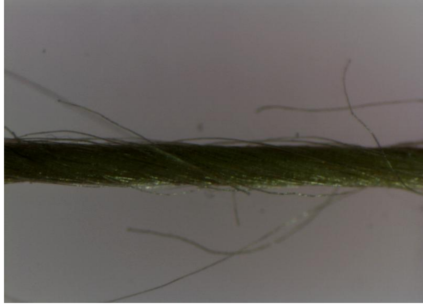
Ek Şekil 7. 45X büyütme oranında %99/1 Twaron®/karbon lifi karışım ipliğinin yanal görüntüsü.
