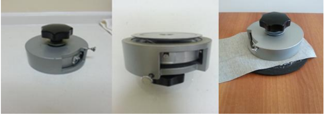
Şekil 2.5. Kumaş gramaj tayini için kullanılan numune kesme aparatı.
