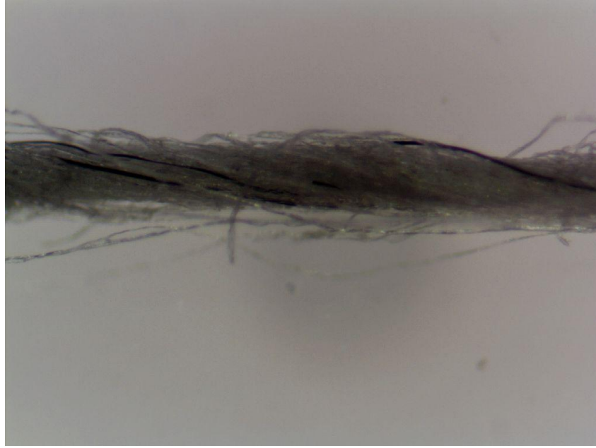
Ek Şekil 6. 45X büyütme oranında %99/1 pamuk/karbon lifi karışım ipliğinin yanıl görüntüsü.
