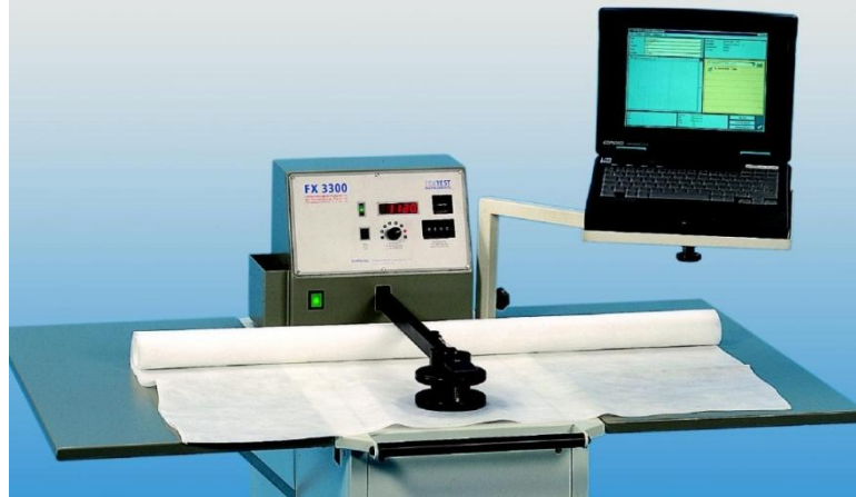
Şekil 1.24. FX 3300 hava geçirgenliği test cihazı (TEXTTEST AG.) [104].
