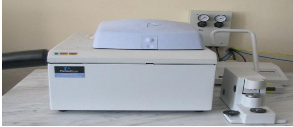
Şekil 2.15. Numunelerin termal analizinde kullanılan Perkin Elmer Diamond DSC cihazı.
