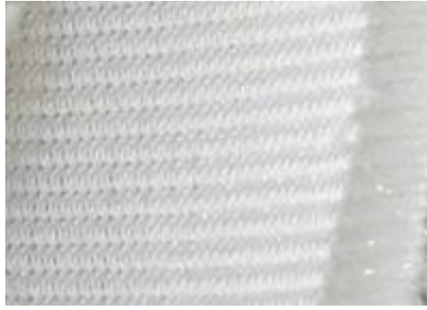
Şekil 1.3. Kapalı yüzeyli üç boyutlu boşluklu örme kumaş [5].
