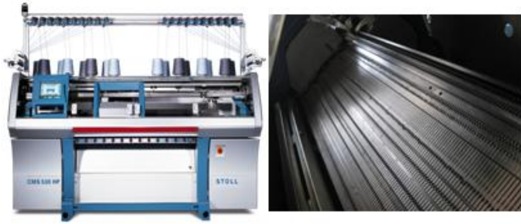
Şekil 1.5. Stoll firmasının ürettiği CMS 530 model elektronik düz örme makinesi [22].
