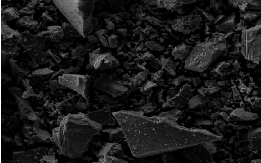
Resim 4.9. Ti-Fe kataliz r nde mapping iřlemi uygulanan b lgenin SEM fotoğrafi
