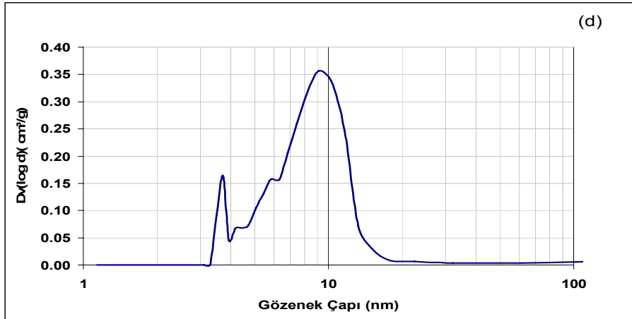
Şekil 4.6.d. Ti(1)-Fe(3) katalizörünün BJH (Barrett-Joynes-Halenda) yöntemiyle belirlenen gözenek çap dağılımı
