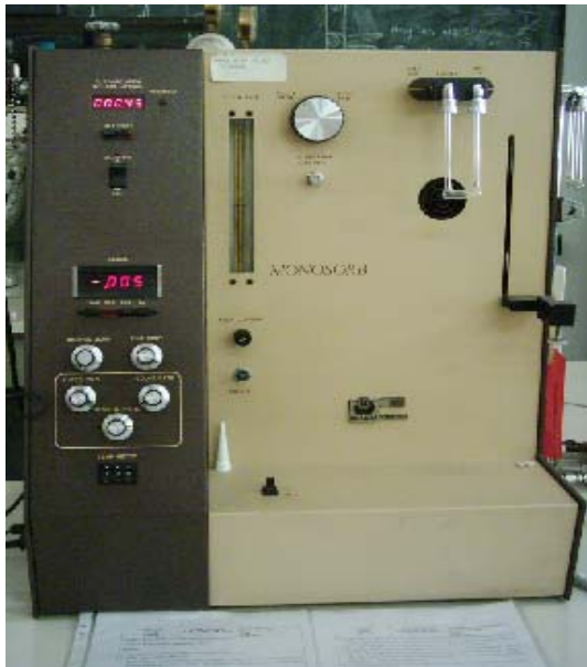
Resim 2.1. Tek nokta BET yüzey alanının belirlendiği Quantachrome Monosorb sorptometre cihazı
