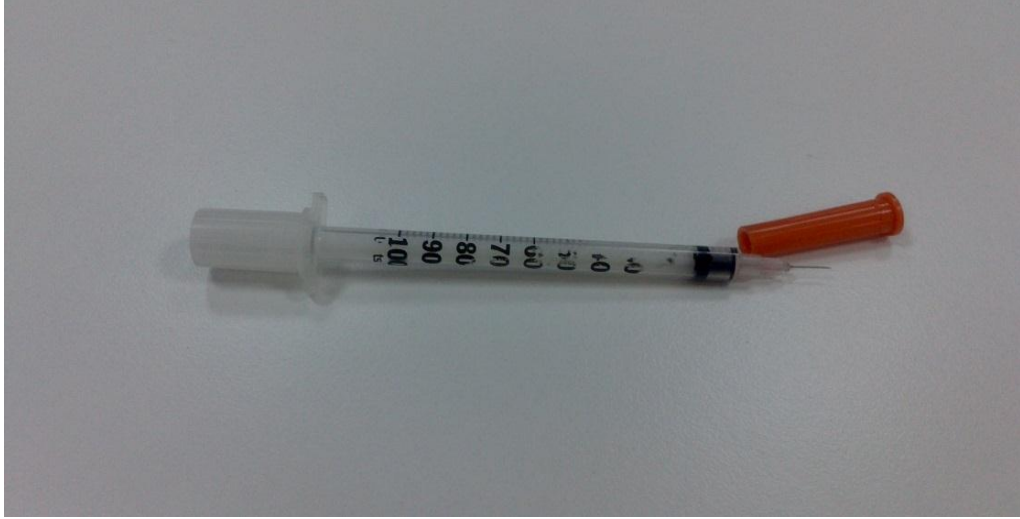
Şekil 5.6. Sıvı kristal hücreleri doldurmak için kullanılan insülin enjektör.
