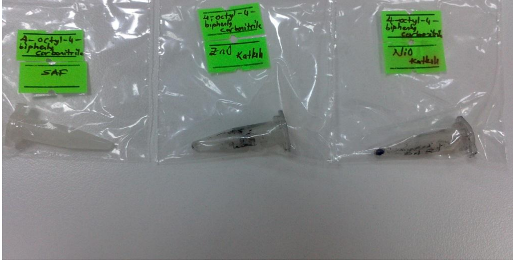
Şekil 5.4. PCR tüplerine doldurulan saf 8CB, ZnO katkılı 8CB ve NiO katkılı 8CB sıvı kristal numuneleri.
