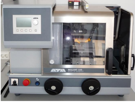
Resim 6.3. ATM Brilliant 250 model kesme cihazı
