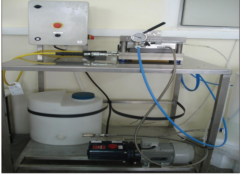
Şekil 2.1 Laboratuvar ölçekli çapraz akışlı düz tabaka membran test ünitesi.
