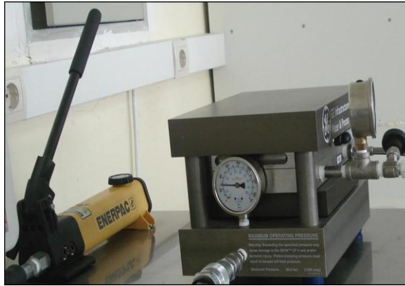
Şekil 2.6 Hücre tutucu ve hidrolik el pompası.
