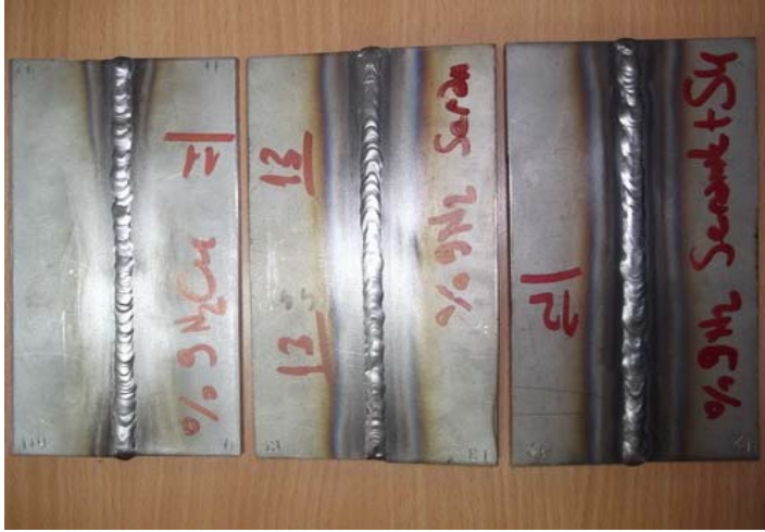
Resim 4.10. Ar +%9 N 2 karışım koruma gazıyla bakır, seramik ve seramik altlık kullanılarak birleştirme sonrası suda soğutularak elde edilen birleştirmeler
