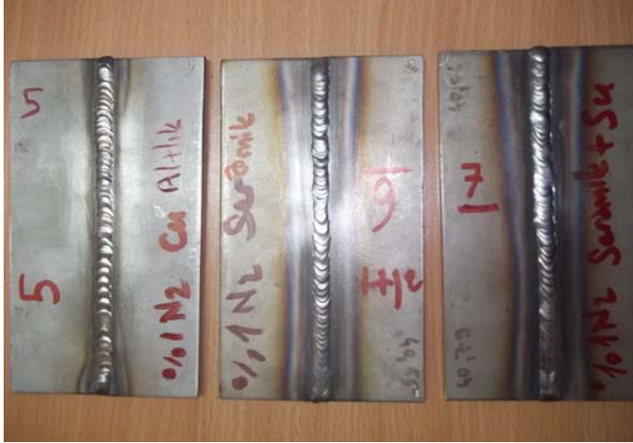
Resim 4.7. Ar +%1 N 2 karışım koruma gazıyla bakır, seramik ve seramik altlık kullanılarak birleştirme sonrası suda soğutularak elde edilen birleştirmeler
