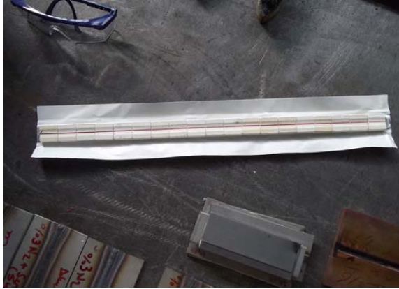
Resim 4.4. Kendinden yapışkanlı seramik kaynak altlığı
