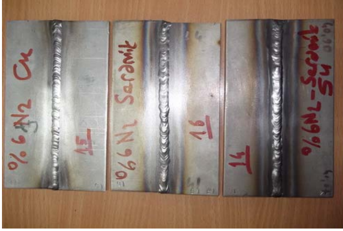
Resim 4.9. Ar +%6 N 2 karışım koruma gazıyla bakır, seramik ve seramik altlık kullanılarak birleştirme sonrası suda soğutularak elde edilen birleştirmeler
