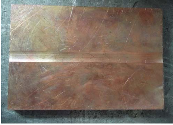
Resim 4.3. Saf elektrolitik bakırdan imal edilmiş kaynak altlığı
