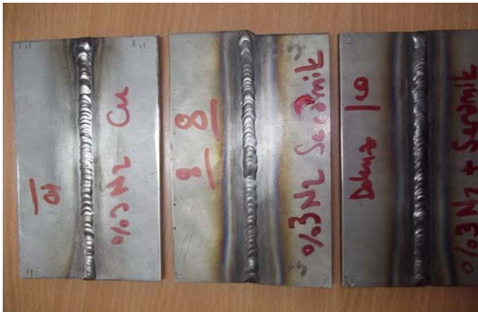
Resim 4.8. Ar +%3 N 2 karışım koruma gazıyla bakır, seramik ve seramik altlık kullanılarak birleştirme sonrası suda soğutularak elde edilen birleştirmeler
