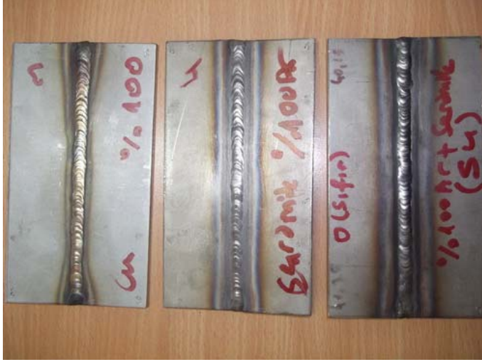
Resim 4.6. Saf argon koruma gazıyla bakır, seramik ve seramik altlık kullanılarak birleştirme sonrası suda soğutularak elde edilen birleştirmeler
