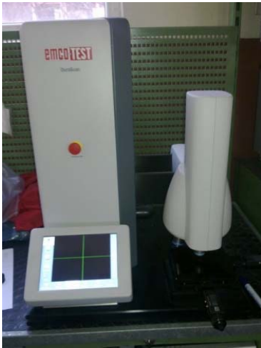
Resim 4.13. Mikrovikers sertlik ölçüm tezgahının görünümü
