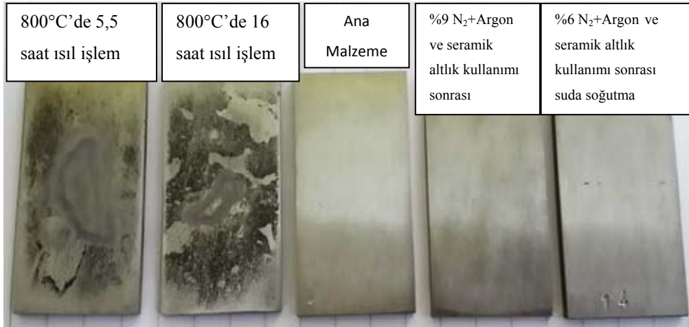
Resim 5.35. Korozyon testi sonrası örnek numune görüntüleri (En düşük korozyon dayanımı veren 800°C'de 5,5 ve 16 saat bekletilerek ısıtıl işlem uygulanan ana malzemeler (F1, F2), %9 N 2 +Argon karışım gazı ile seramik altlık kullanılan kaynaklı numuneler (E-3), en yüksek korozyon direnci gösteren ana malzeme (A) ve %6 N 2 +Argon karışım gazı ile seramik altlık kullanılarak suda soğutulan korozyon test numuneleri, D-2)
