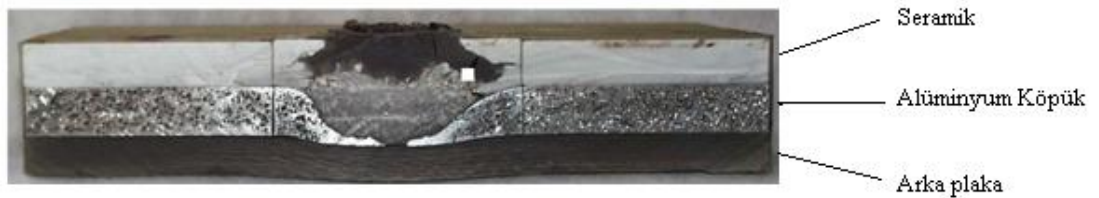
Şekil 2.7: Alüminyum köpük kullanılmış zırh paketi
