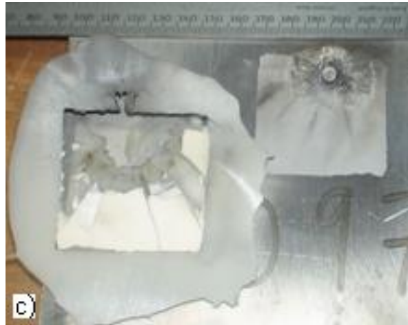
Şekil 6.19: 3. Balistik test numunelerinin atış öncesi (a) ve sonrası (b, c) görüntüleri.
