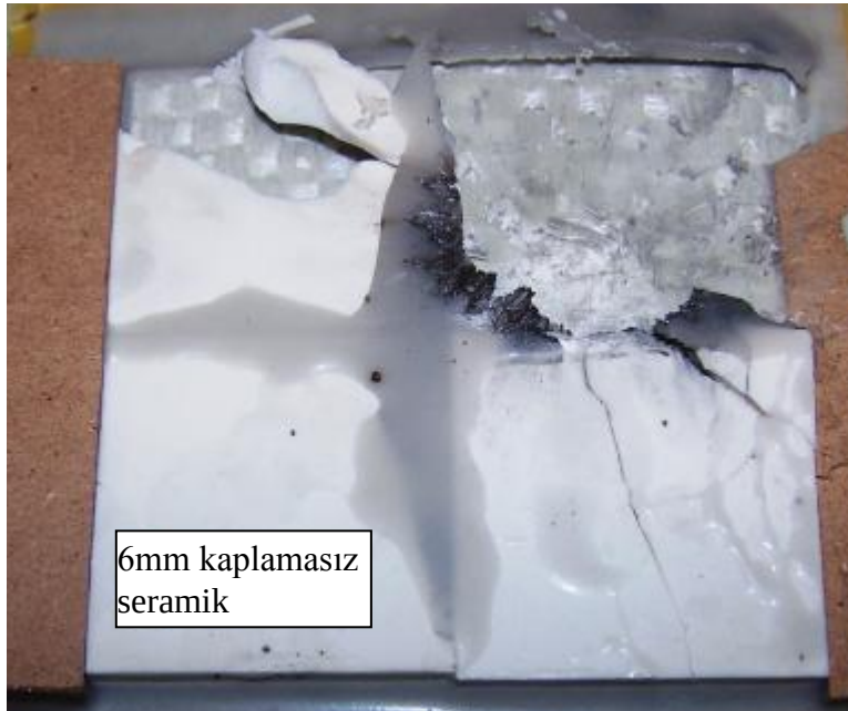
Şekil 6.29: Kaplama yapılmamış seramikte balistik test sonrası meydana gelen çatlak ilerlemesi görünümü
