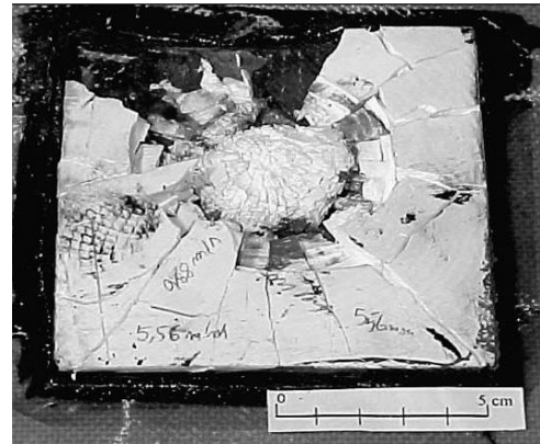
Şekil 2.2: Seramiklerde balistik darbe sonrası meydana gelen çatlak formu [5].
