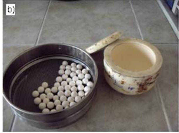
Şekil 5.2: Kaplama malzemelerinin karıştırılmasında kullanılan a) gezegen tipi değirmen b) bilyalar ve öğütme kabı
