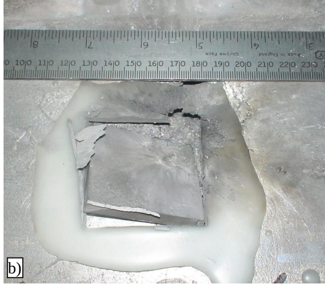
Şekil 6.31: 6. Balistik test numunelerinin atış öncesi (a) ve sonrası (b) görüntüleri
