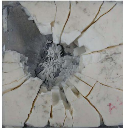
Şekil 2.2: Seramiklerde balistik darbe sonrası meydana gelen çatlak formu [5].
