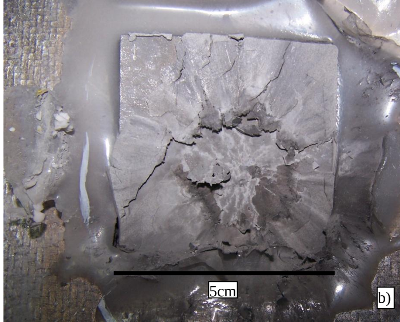
Şekil 6.17: 2. Balistik test numunelerinin atış öncesi (a) ve sonrası (b) görüntüsü.
