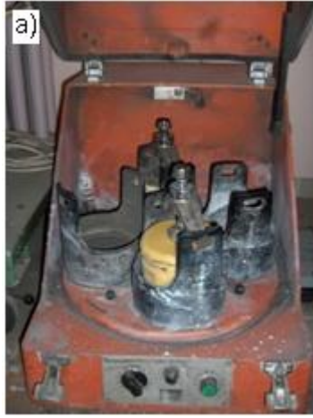
Şekil 5.2: Kaplama malzemelerinin karıştırılmasında kullanılan a) gezegen tipi değirmen b) bilyalar ve öğütme kabı
