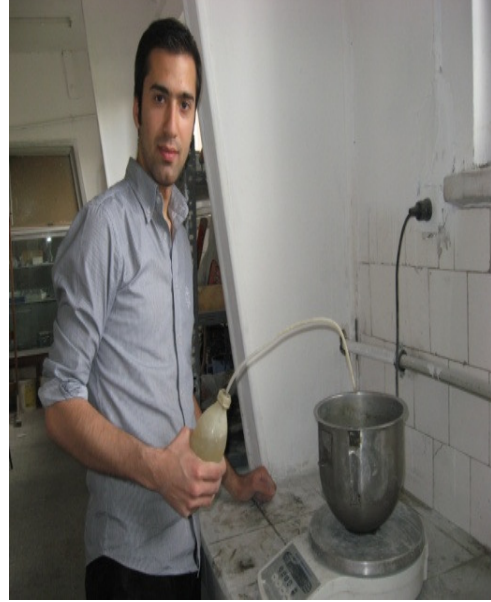
Resim 1.5. Harç karışımlarında belirlenen su miktarının hassas terazide tartılması.
