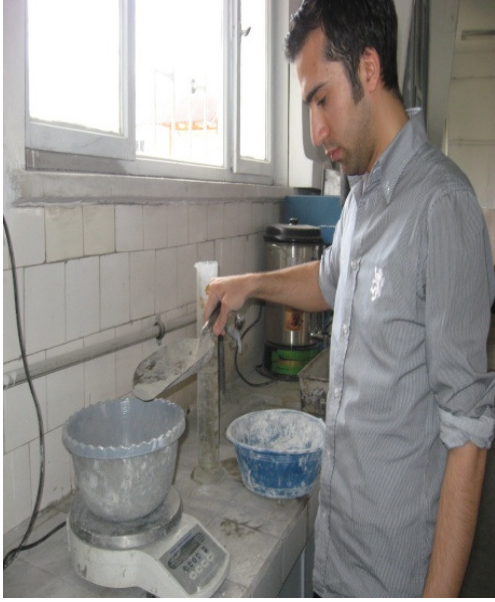
Resim 1.6. Harç karışımlarının hazırlanması ve mikserde karıştırılması.
