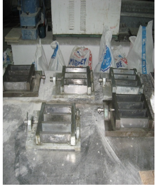
Resim 1.7. Harç karışımlarının kalıplara yağlanarak konulması.
