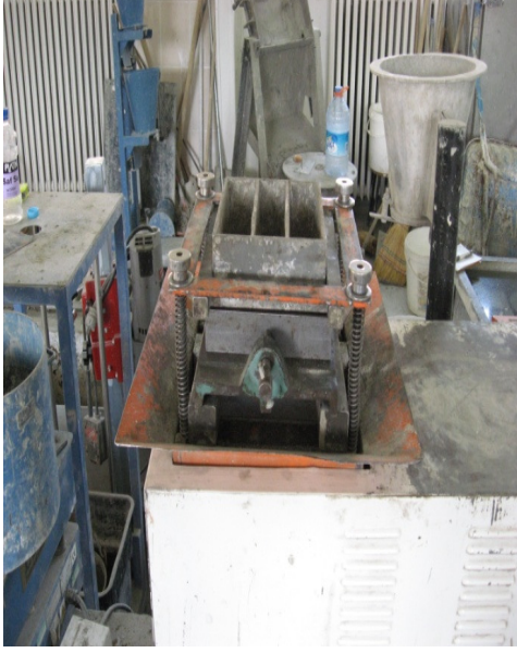
Resim 1.8. Harç karışımlarının kalıplara yerleştirilmesi.
