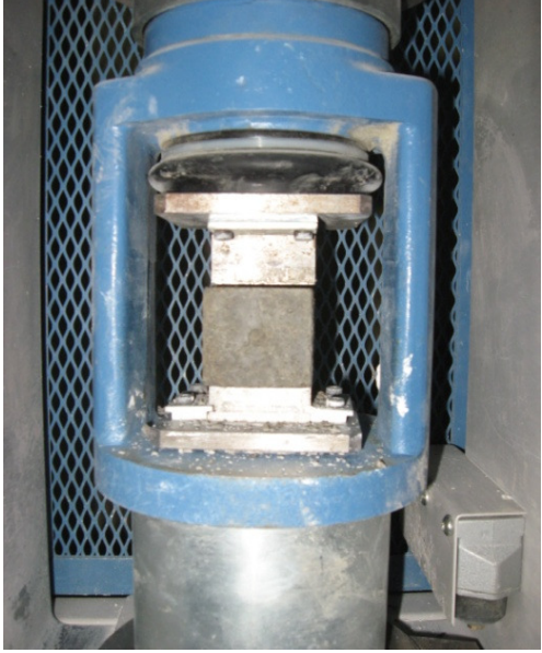
Resim 1.15. Harç örneklerinin basınç deneyi.
