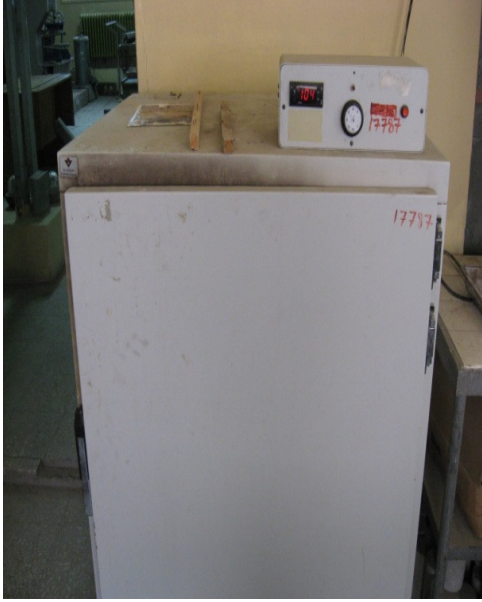
Resim 1.10. Yüksek sıcaklık öncesi örneklerin etüv fırınında kurutulması.
