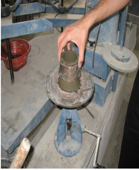
Resim 1.4. Harçların sarsma tablasındaki akma miktarının tespit edilmesi.
