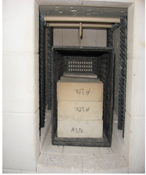
Resim 1.12. Harç örneklerinin yüksek sıcaklık fırınına yerleştirilmesi.
