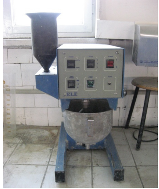
Resim 1.6. Harç karışımlarının hazırlanması ve mikserde karıştırılması.
