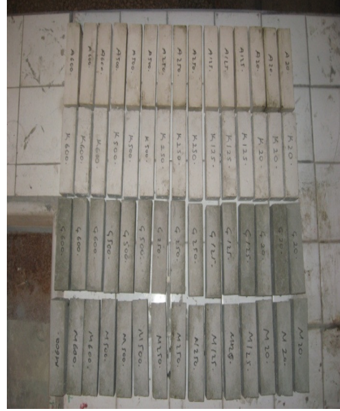
Resim 1.9. Harç karışımlarının laboratuvar koşulunda kür edilmesi.
