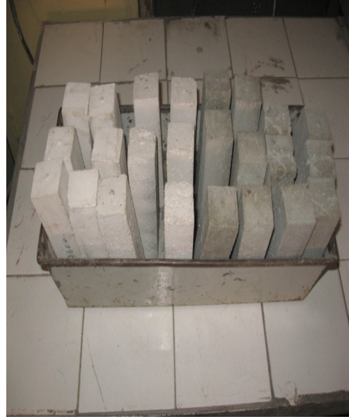
Resim 1.10. Yüksek sıcaklık öncesi örneklerin etüv fırınında kurutulması.
