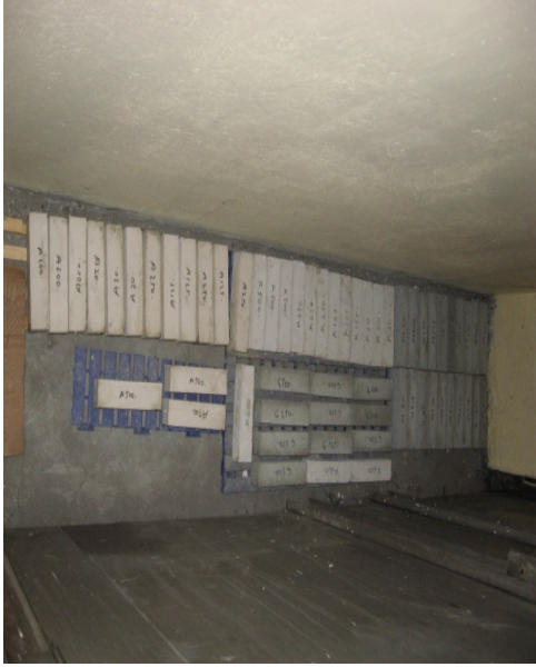
Resim 1.9. Harç karışımlarının laboratuvar koşulunda kür edilmesi.
