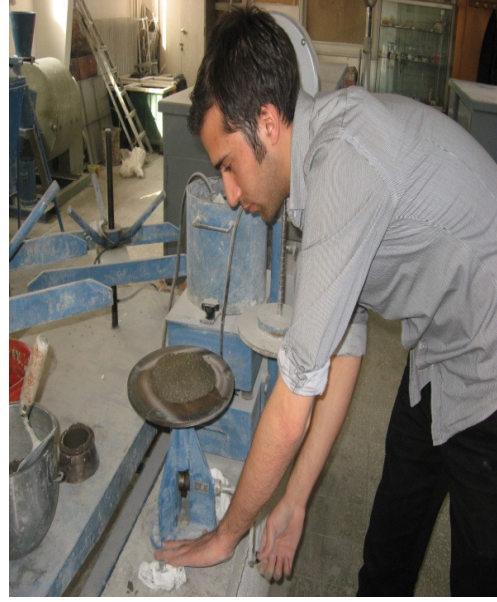
Resim 1.4. Harçların sarsma tablasındaki akma miktarının tespit edilmesi.
