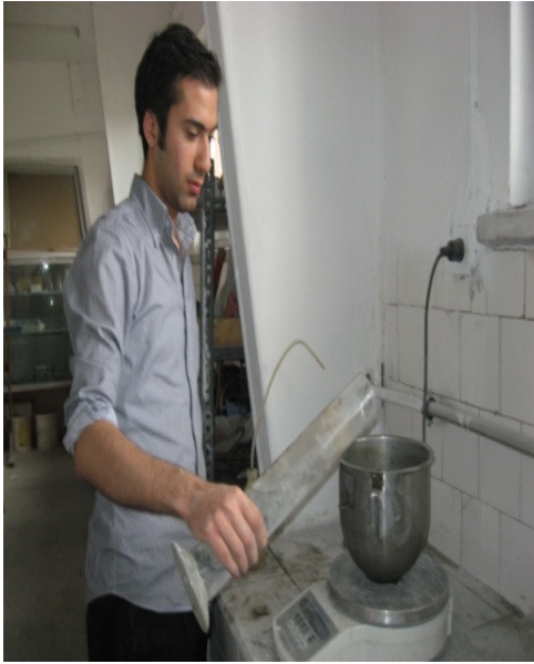
Resim 1.5. Harç karışımlarında belirlenen su miktarının hassas terazide tartılması.
