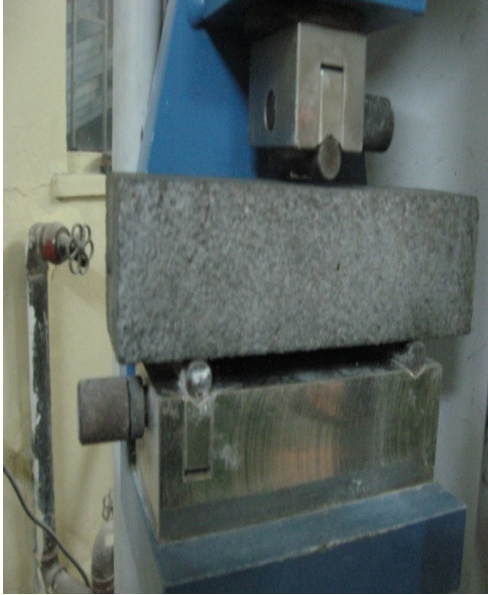
Resim 1.14. Harç örneklerinin eğilmede çekme deneyi.
