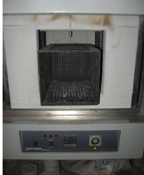
Resim 1.10. Yüksek sıcaklık öncesi örneklerin etüv fırınında kurutulması.
