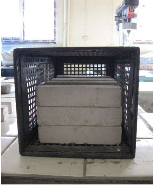
Resim 1.12. Harç örneklerinin yüksek sıcaklık fırınına yerleştirilmesi.
