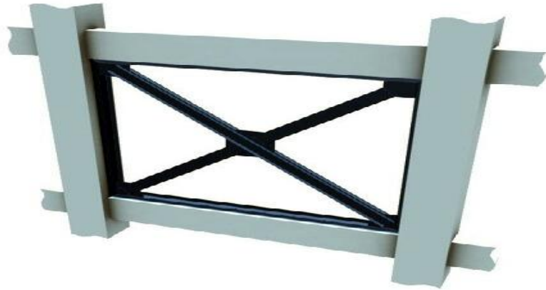
Şekil 3.45. Çerçeve açıklığının çelik çapraz elemanlarla güçlendirilmesi
