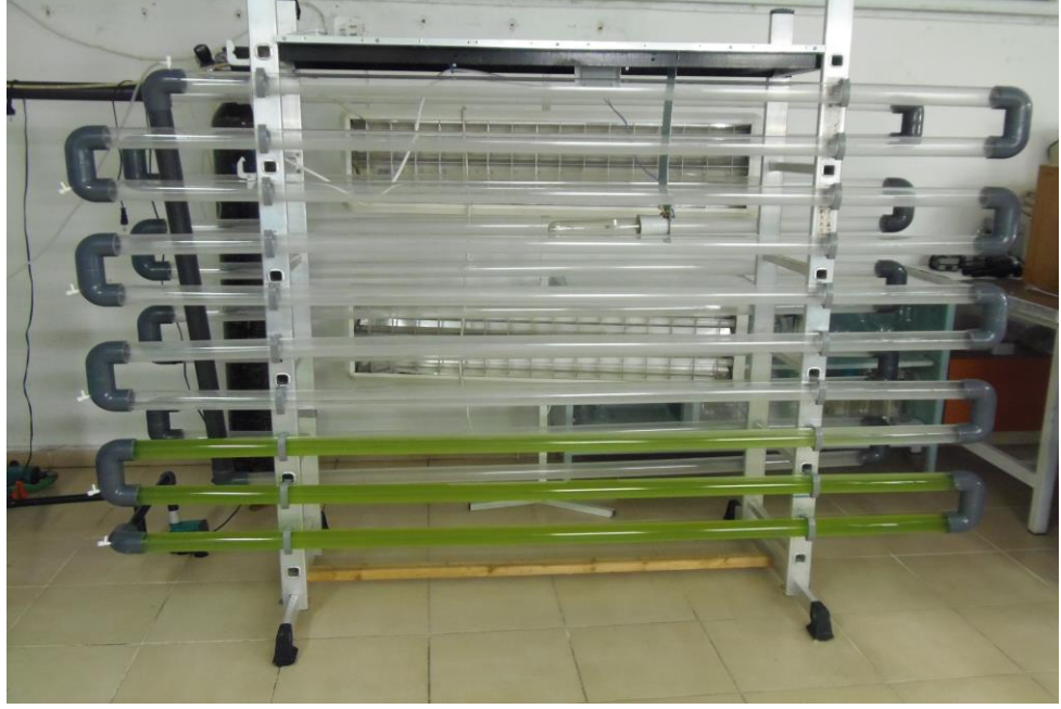
Şekil 3.11 İkinci üretimde toplama tankından sisteme kültürün verilmesi ve üretimin başlama anı.
