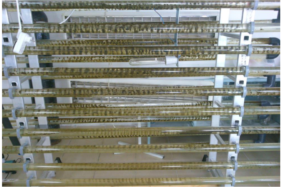
Şekil 3.18 İlk üretimden sonra tübüler fotobiyoreaktördeki akrilik borularda yaşanan yapışma sorunu
