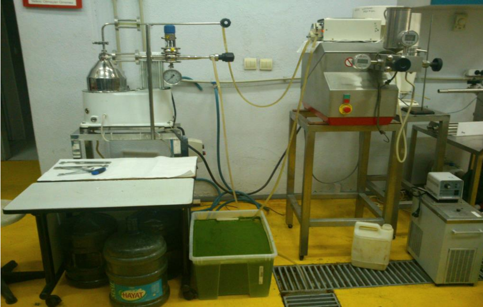
Şekil 3.23 Chlorella vulgaris ’ in hasat işleminden sonra santrifüj işleminin yapıldığı separatör.
