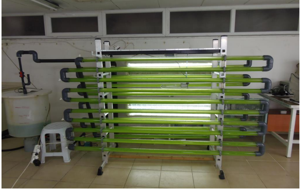
Şekil 3.8 İlk üretimde üretim periyodu başlangıcında tübüler fotobiyoreaktörün etrafına konulan ayaklı floresan lambalarla görünümü.
