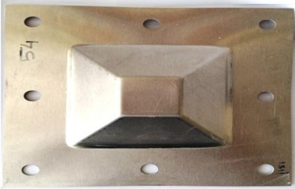
Şekil 4.22. Sıvama yağı, 0,5 mm dikey ilerleme, ısıt işlem görmüş malzeme ve 2. takım yolu parametrelerine sahip numunenin görünüşleri
