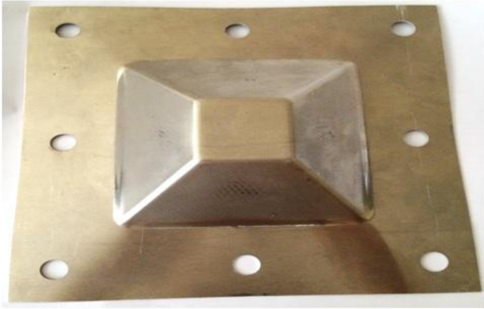
Şekil 4.14. Sıvama yağı, 0,2 mm dikey ilerleme, ısıt işlem görmüş malzeme ve 1. takım yolu parametrelerine sahip numunenin görünüşleri
