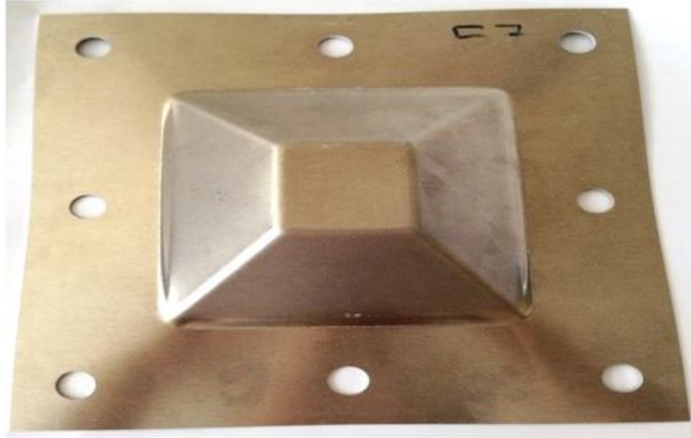
Şekil 4.9. Bor yağı, 0,5 mm dikey ilerleme, ısıt işlem görmemiş malzeme ve 1. takım yolu parametrelerine sahip numunenin görüşleri
