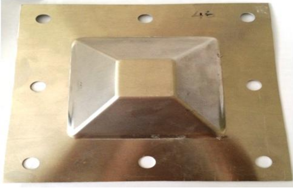
Şekil 4.15. Bor yağı, 0,2 mm dikey ilerleme, ısıt işlem görmüş malzeme ve 1. takım yolu parametrelerine sahip numunenin görünüşleri
