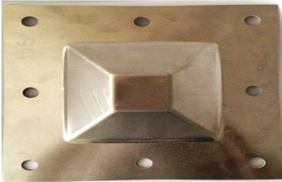
Şekil 4.21. Bor yağı, 0,5 mm dikey ilerleme, ısıt işlem görmemiş malzeme ve 3. takım yolu parametrelerine sahip numunenin görünüşleri
