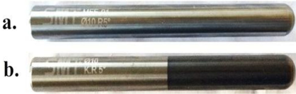
Şekil 3.2. a) Kaplamasız karbür b) Krom-nitrür kaplamalı takım
