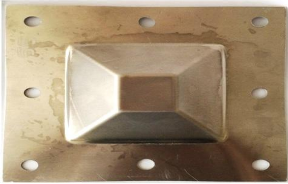
Şekil 4.20. Sıvama yağı, 0,5 mm dikey ilerleme, ısıt işlem görmemiş malzeme ve 3. takım yolu parametrelerine sahip numunenin görüşleri
