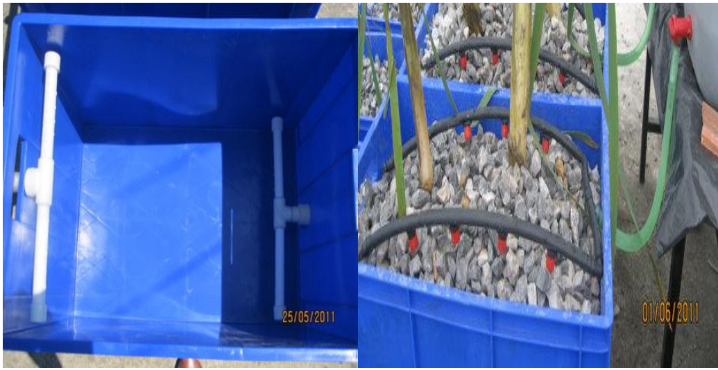
Şekil 3.6. Yatay ve düşey akışlı havuzların giriş ve çıkış yapıları
