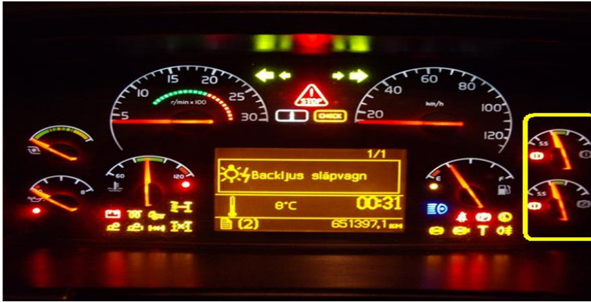
Resim 3.13. Araçta bulunan manometreler
