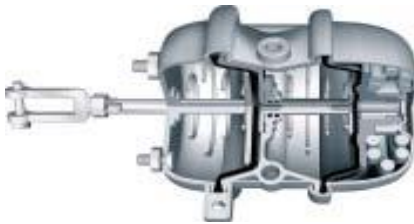
Resim 3.11. Kombi fren silindiri [46]
