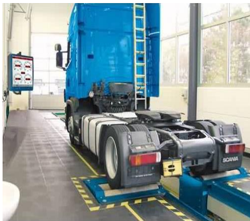
Resim 5.2. Fren test cihazı tamburları
