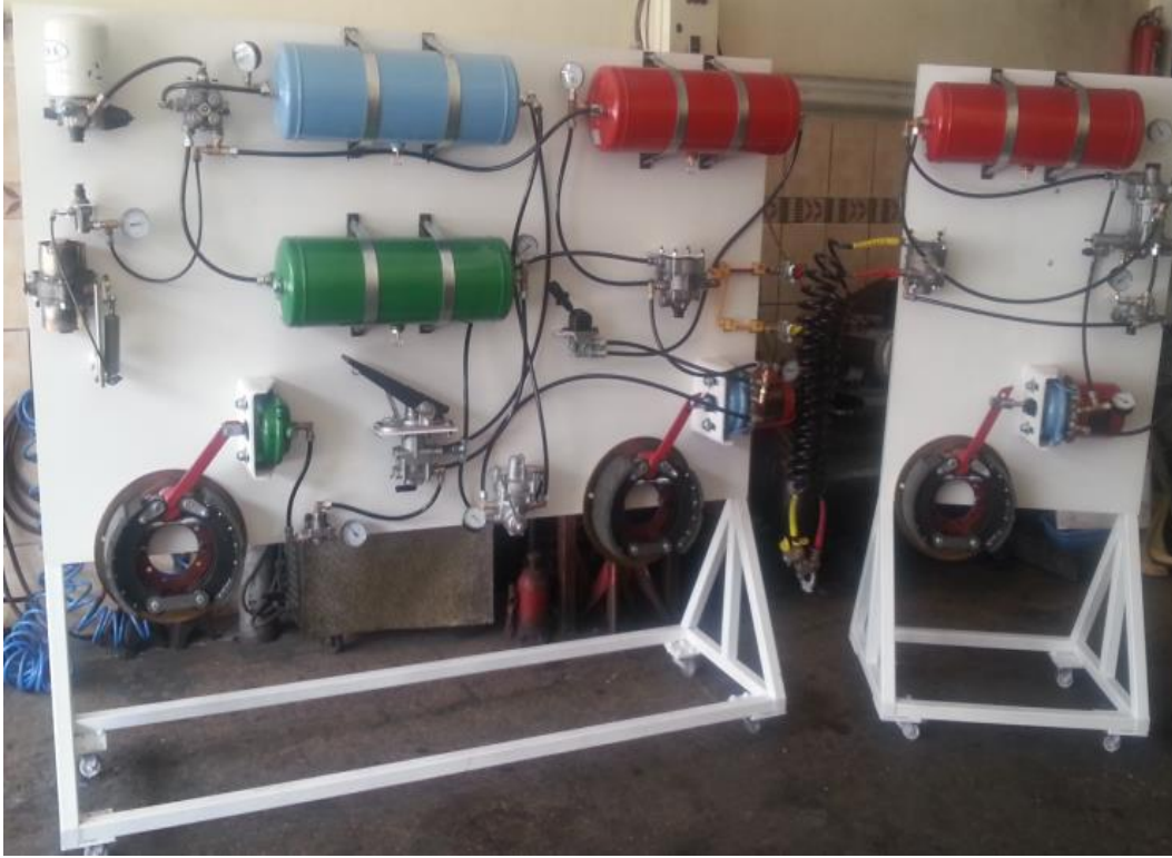
Resim 5.17. Geliştirilen havalı fren sistemleri test panosu
