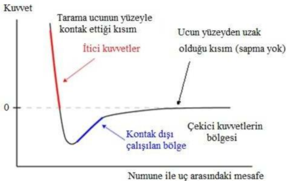
Şekil 4.14. Atomik kuvvet mikroskobunda uç-numune etkileşmesi (Söyleyici, 2011).
