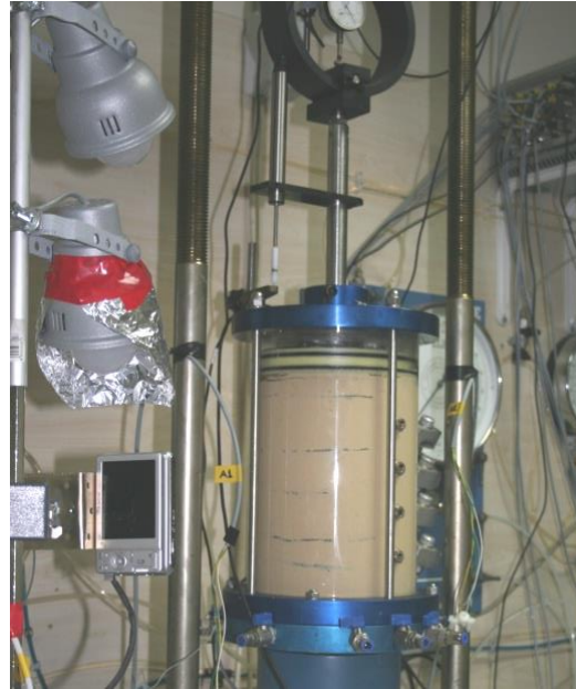
Şekil 3.21: Büyük konsolidasyon hücrelerinde düşey deformasyonların fotogrametrik yöntemle takibi için oluşturulan sistem.
