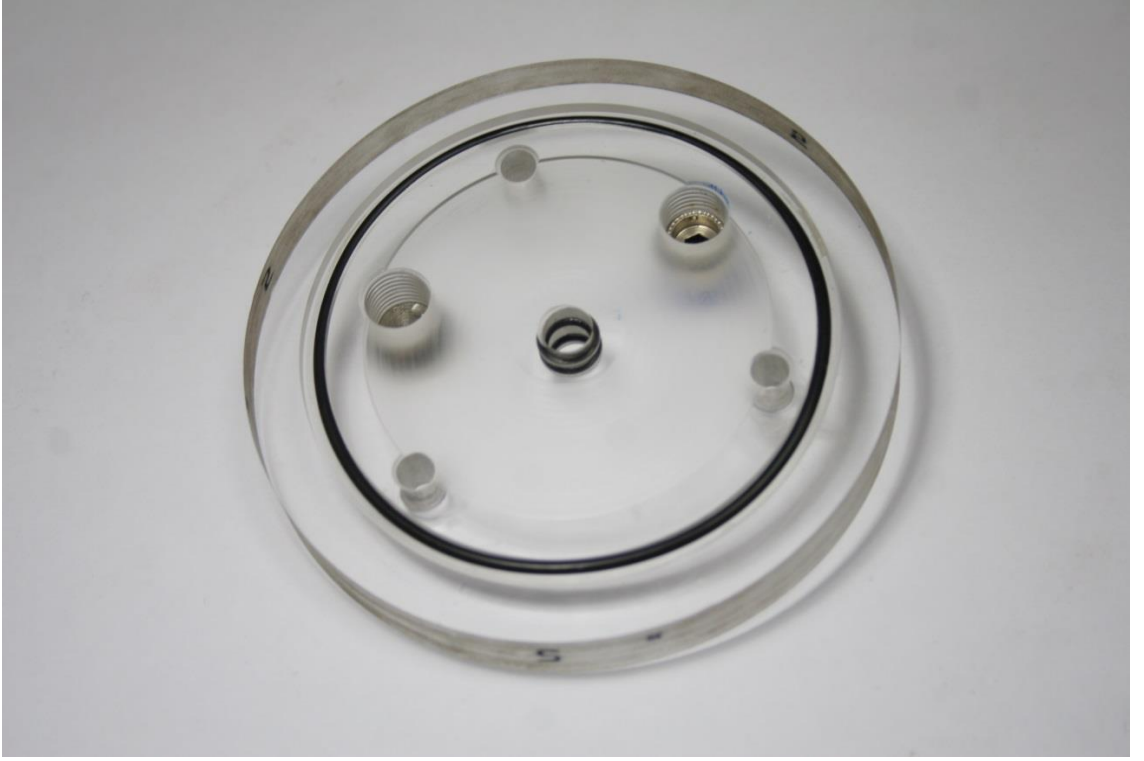
Şekil 3.4: Konsolidasyon hücresi kapağının alt yüzü.
