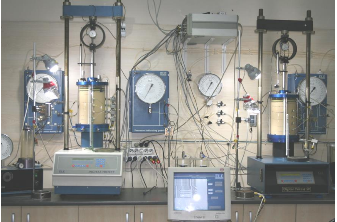
Şekil 4.34: Büyük numunelerde CRS deney düzeneği.
