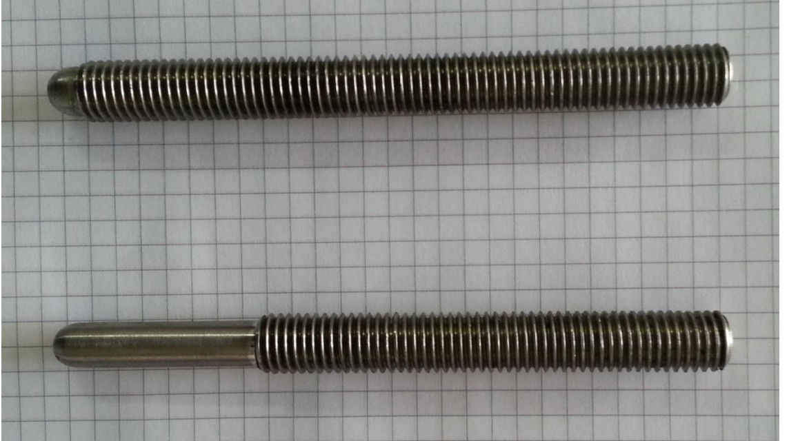
Şekil 3.5: Ödometre yükleme kolunda yapılan değişiklik sonucu oluşturulan piston.
