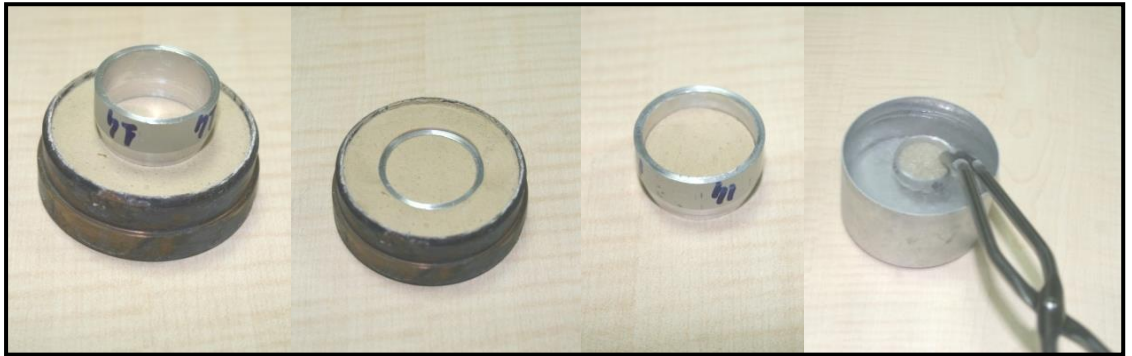
Şekil 4.24: Küçük boyutlu CRS konsolidasyon deneyi sonrası ESEM görüntüsü için numune alma işlemi.
