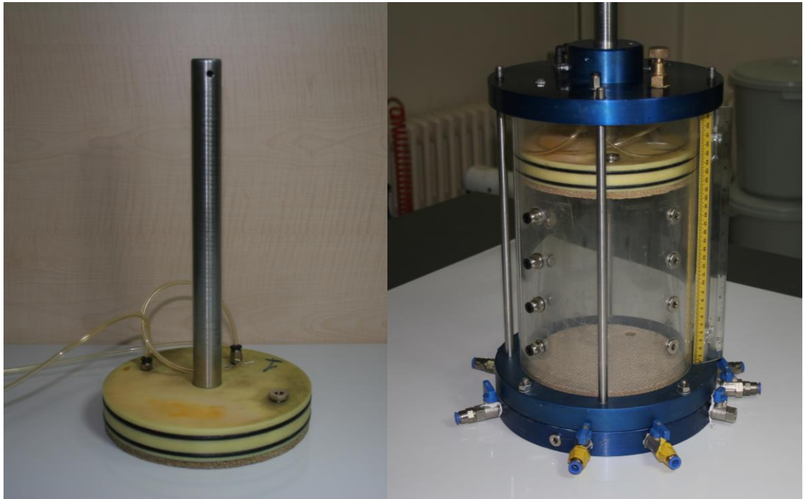
Şekil 3.11: Büyük konsolidasyon hücresinde kullanılan piston ve büyük konsolidasyon hücresi.
