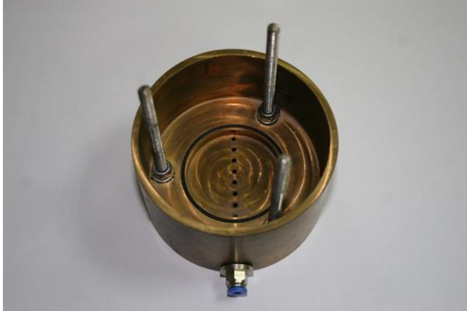
Şekil 3.1: Konsolidasyon hücresi tabanında boşluk suyu basıncı ölçümü için yapılan değişiklik.
