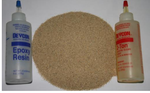
Şekil 3.12: Poroz taş imalatında kullanılan kum ve epoksi yapıştırıcı.
