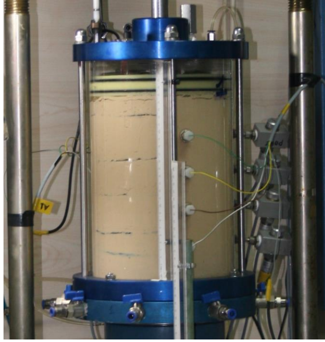
Şekil 3.17: Büyük konsolidasyon hücresinde elektrik direnci ölçümü.
