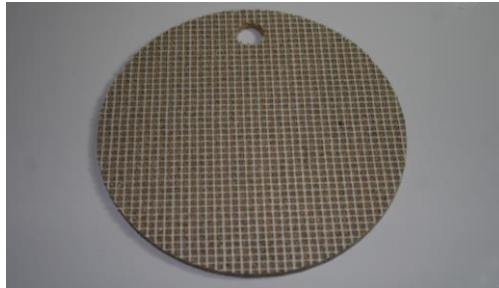
Şekil 3.15: Polyüratan file kaplanmış poroz taş.
