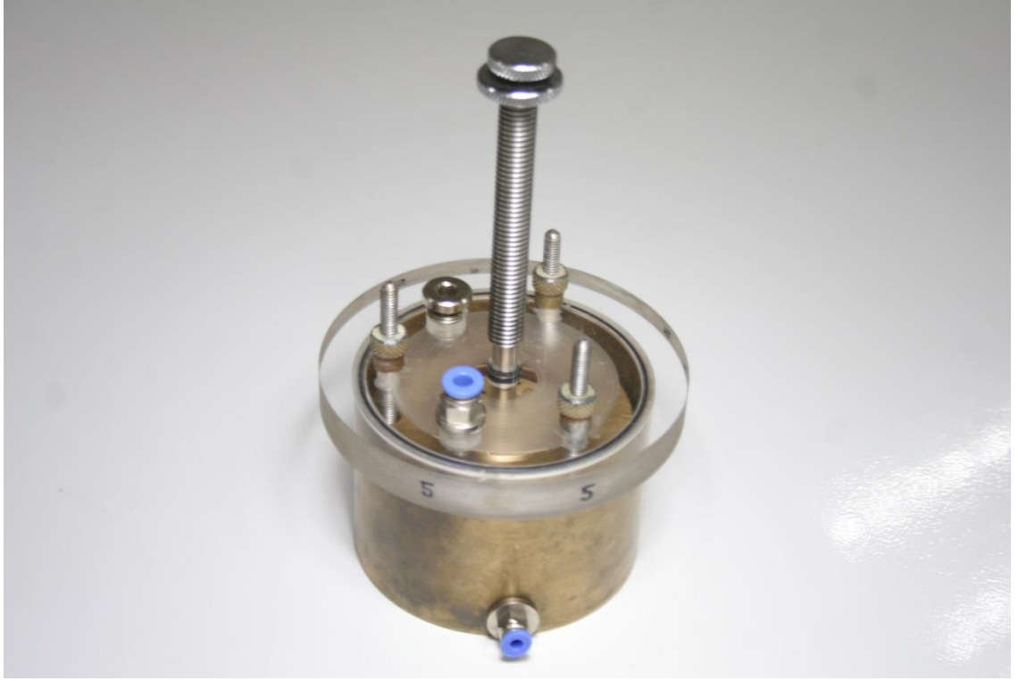
Şekil 3.8: Konsolidasyon hücresinde, kapak ve yükleme kolunun yerleştirilmiş hali.
