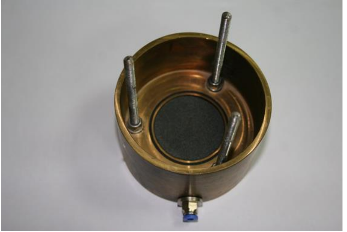
Şekil 3.2: Konsolidasyon hücresi tabanındaki yuvaya poroz taş yerleştirilmiş hali.
