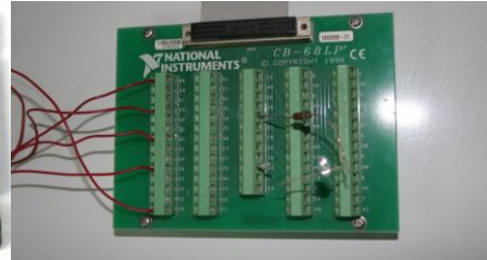
Şekil 3.18: Büyük konsolidasyon hücresinde elektrik direnci ölçümünde akımı yönlendiren anahtar düzeneği.
