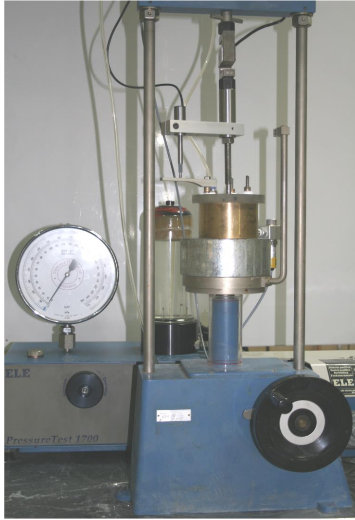
Şekil 4.23: Serbest basınç yükleme çerçevesine yerleştirilmiş CRS hücresi.
