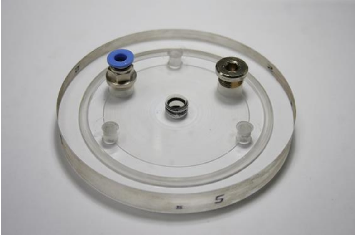
Şekil 3.3: Konsolidasyon hücresi kapağının üst yüzü.
