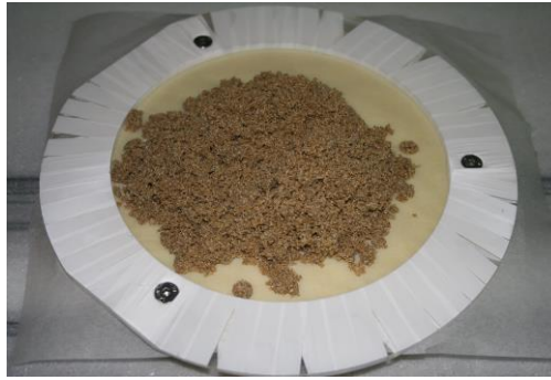
Şekil 3.13: Poroz taş kalıbına dökülen epoksi yapıştırıcı kum karışımı.
