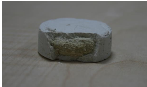
Şekil 3.25: Süblimleşme yöntemiyle kurutulurken kurutma işlemi yarıda kesilmiş kaolin numunesi.
