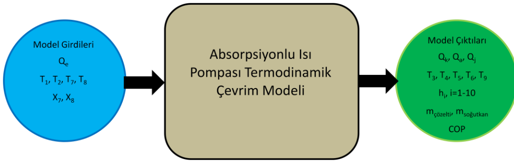
Şekil 4.11. Absorpsiyonlu çevrim Matlab modelinin şematiği
