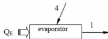
Şekil 4.8.Çevrimdeki evaporatör bileşeninin şematik gösterimi.
