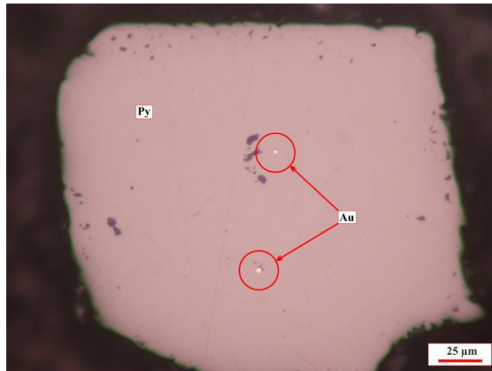
Şekil 4.19 V. Viraj cevherleşmesindeki pirit içinde gözlenen küçük altın taneleri (// nikol görünümü).
