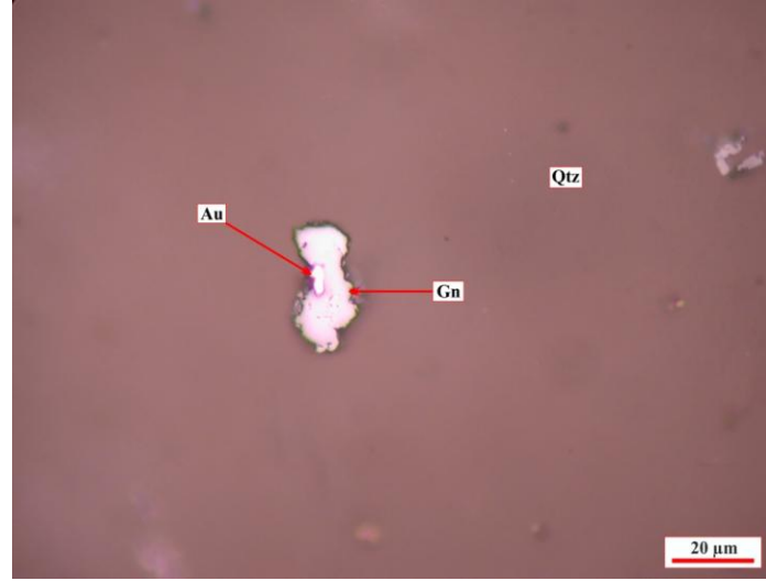
Şekil 4.20 V. Viraj cevherleşmesinde kuvarşın içinde galen ile ilişkili altın tanesi (// nikol görünümü).
