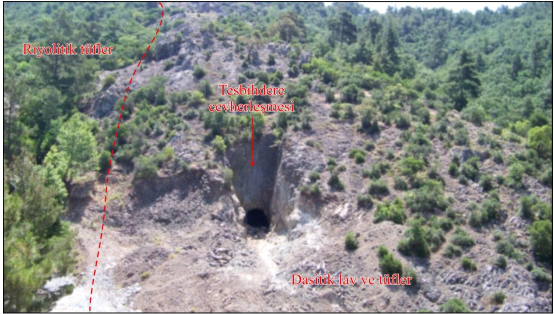
Şekil 3.4 Kuru Pb-Zn yatağının doğusunda yer alan Tesbihdere cevherleşmesinin galeri girişi. Cevherleşme, dasitik lav ve tüfler ile riyolitik tüflerin dokanağında D-B uzanımlı damar tipi olarak gözlenmektedir.
