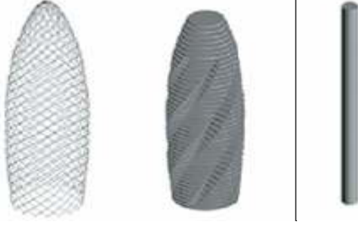
Şekil 5.8. Swiss Re Tower, taşıyıcı sistem-yüzey [Anon, 2006].
