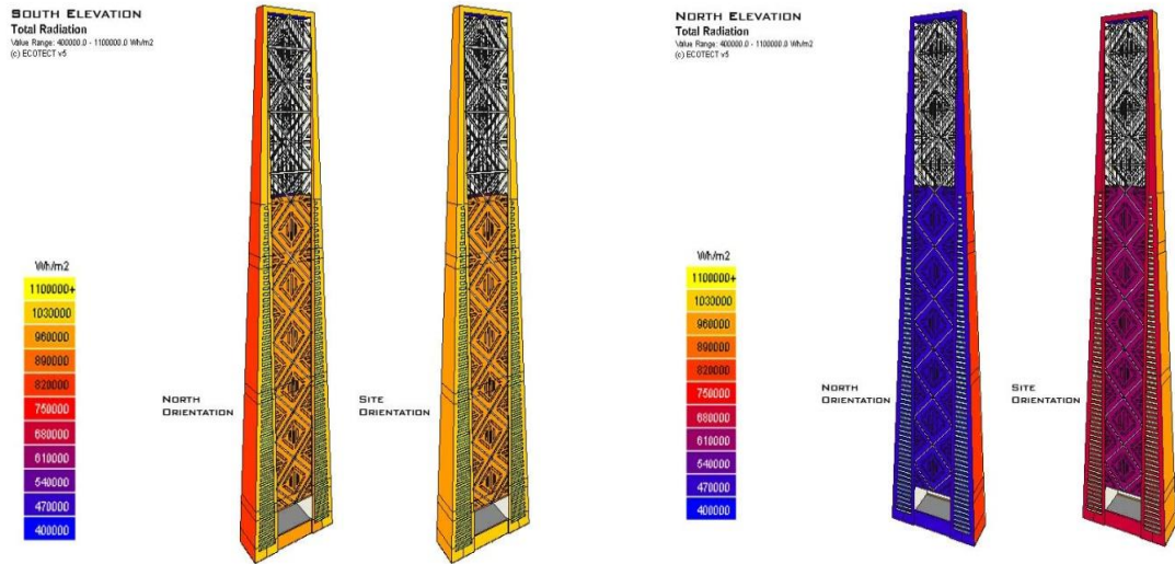
Şekil 5.45. Light Tower, güneş enerjisinin yüzey üzerindeki etkileri [Atkins, 2011].
