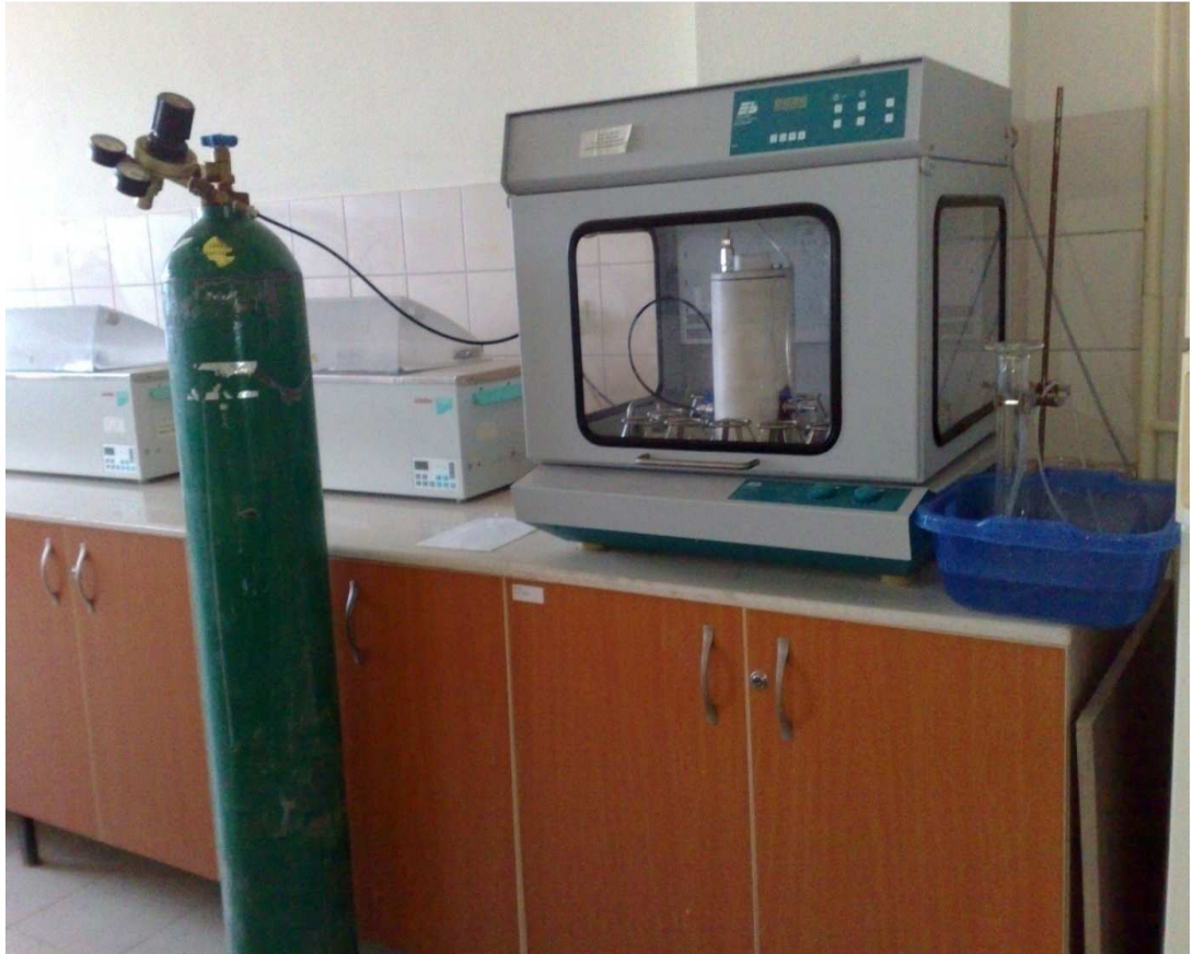
Şekil 3.2. Anaerobik fermantasyon ile biyohidrojen üretimi deney düzeneği.
