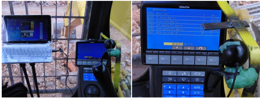
Şekil 3.5 Yükleyici veri izleme ekranından alınan verilerin digital formatta kaydedilmesi.
