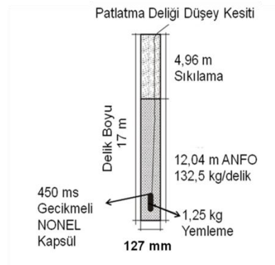
Şekil 4.81 Deney 3 patlatma deliği düşey kesiti planı (ölçeksiz).
