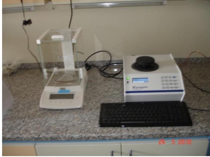
Şekil 5.1 Yoğunluk testlerinde kullanılan helyum piknometre.
