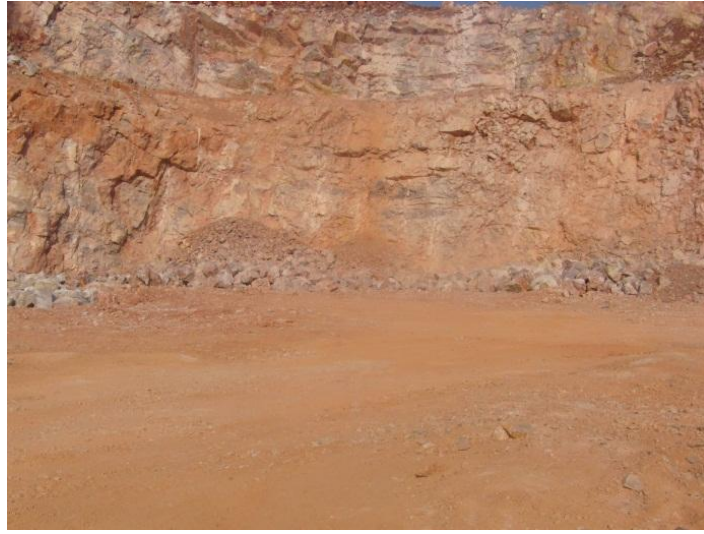
Şekil 4.61 Deney 12'ye ait patlatma aynası görüntüsü.
