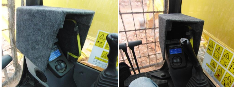
Şekil 3.4 Yükleyici veri izleme ekranından titreşim ve güneş ışınlarının engellenmesi.
