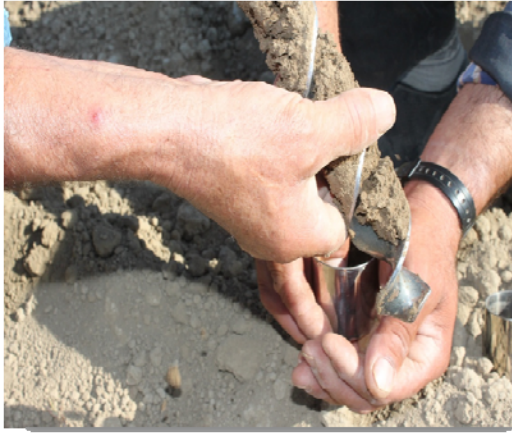
Şekil A.3. Gravimetrik yöntem
