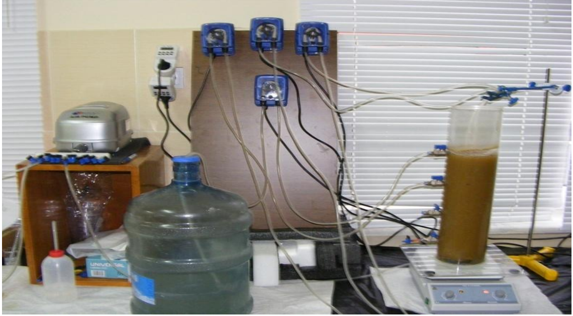
Şekil 2.2. Kolon Tipi Ardışık Kesikli Reaktör
