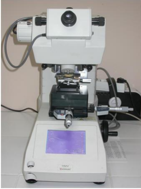
Resim 5.4. Mikrosertlik ölçümlerinin yapıldığı SHIMADZU HMV2 mikro sertlik cihazı
