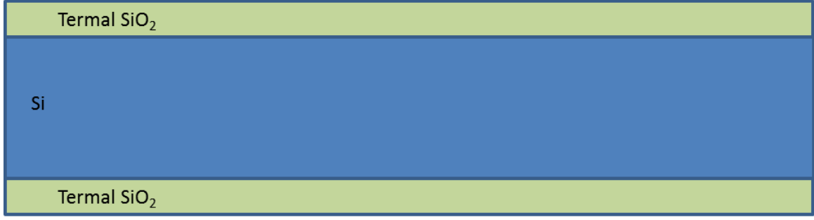
Şekil 6-5 Termal oksit büyütülmüş silisyum alttaş kesit şematiği
