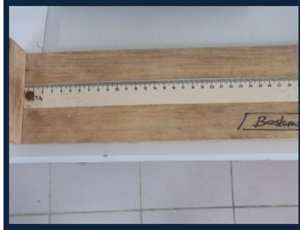
Şekil 3.8. Balık boyunu ölçmede kullanılan boy ölçme tahtası
