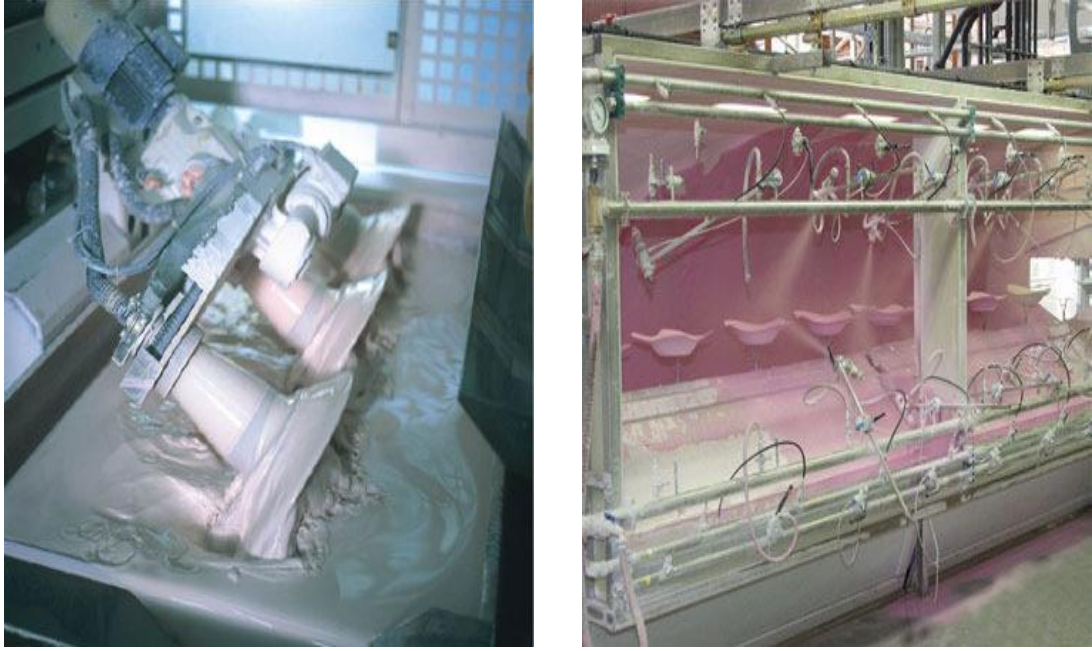
Şekil 3.16 Sırlama (Lippert) makineleri (a) daldırma yöntemi (Lippert (a) 2008) (b) püskürtme yöntemi (Lippert (b) 2008)
