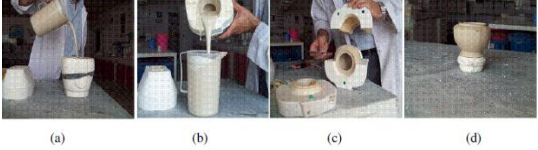
Şekil 3.10 Boş döküm yoluyla şekillendirme (a) çamurun kalıba dökülmesi (b) ürün istenilen kalınlığa ulaştığında çamurun geri boşaltılması (c) kalıbın ayrılması (d) rötuşlanmaya hazır ürün.
