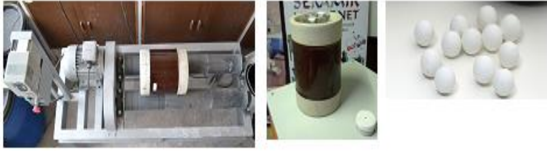
Şekil 5.4 Toz hazırlamada kullanılan değirmen sistemi ve alümina bilyalar.
