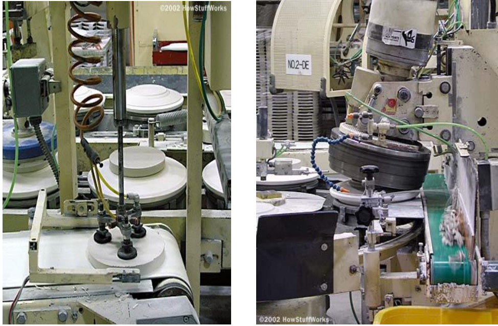
Şekil.3.8 Tornada tabak şekillendirilmesi (a) Sucuk dilimlerinin kalıp üzerine yerleştirilmesi (b)Kafanın dönerek çamuru şekillendirmesi [76].
