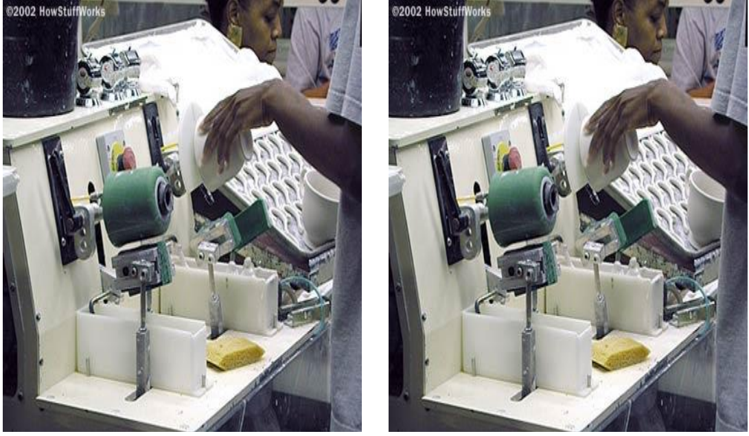
Şekil 3.9 Tornalarda fincan şekillendirilmesi (a) Fincanların şekillendirilmesi (b) Kulp yapıştırma makinesi ile kulpların yapıştırılması [77].
