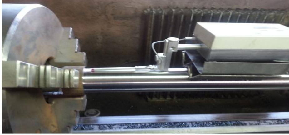
Şekil 5.5 Yüzey pürüzlülüğü ölçme deneyinin yapılışı
