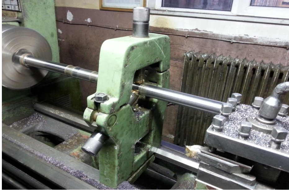
Şekil 5.4 Sabit lunet ile tornalama işlemi
