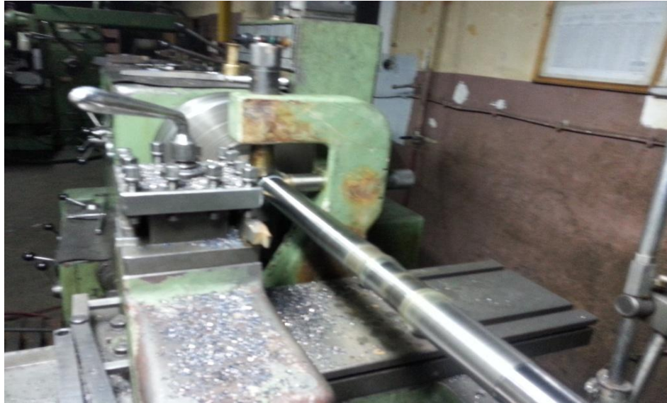
Şekil 5.8 Hareketli lunet ile tornalama işlemi
