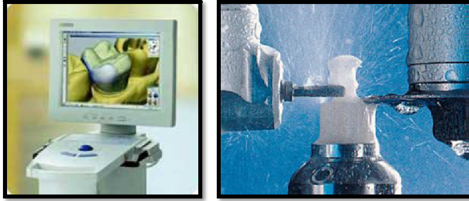
Şekil 2-4: Cerec sistemiyle restorasyon tasarımı ve şekillendirilmesi
