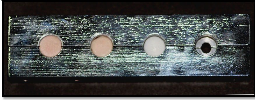
Şekil 3-12: Standart üstyapı seramik kalınlığı elde etmek amacıyla kullanılan paslanmaz çelik kalıp
