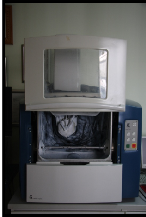
Şekil 3-7: Kavo Everest aşındırma ünitesi
