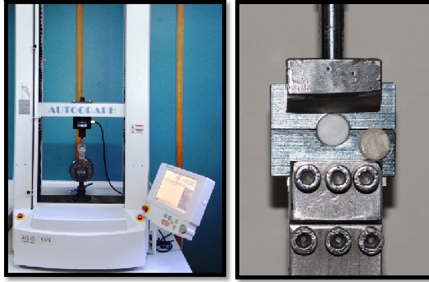
Şekil 3-15: Üniversal test cihazı ve kırılan örneğin test cihazındaki görüntüsü
