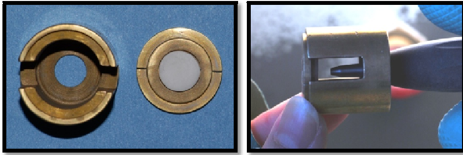
Şekil 3-11: Kumalama cihazının ucunu sabit pozisyonda tutan düzenek ve altyapı örneklerinin yüzeyinin kumlanması
