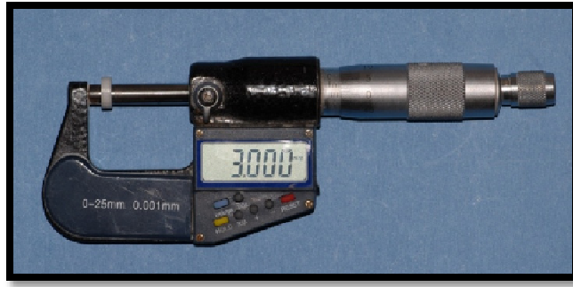
Şekil 3-10: Tamamlanmış altyapı örneği kalınlığının tespiti
