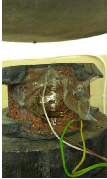
Şekil 3.21. Tuğla numunesi basınç deney deney düzeneği
