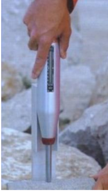
Şekil 3.23. Schmidt çekici ölçüm deneyi
